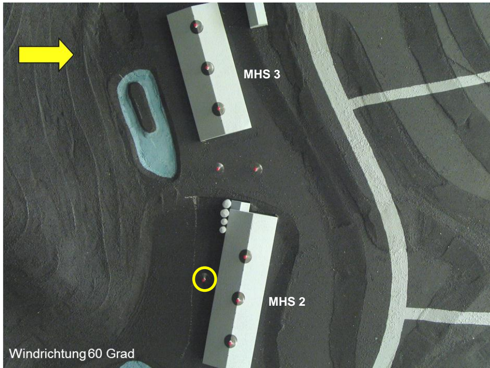
Abb. 4.1: Hügel ohne Wald, Windrichtung 60 Grad: Ausrichtung der Windfähnchen mit der Strömung in 3 m Höhe über First der Ställe MHS 2 und MHS 3 und in 3 m Höhe über Grund. Fähnchen mit Kreis ohne definierte Ausrichtung.
