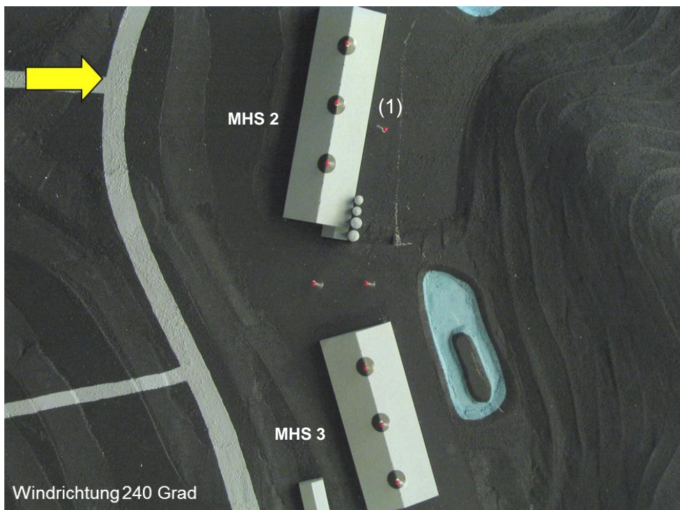
Abb. 4.2: Hügel ohne Wald, Windrichtung 240 Grad: Ausrichtung der Windfähnchen mit der Strömung in 3 m Höhe über First der Ställe MHS 2 und MHS 3 und in 3 m Höhe über Grund. Fähnchen (1) nun in der Rezirkulationszone von MHS 2.
