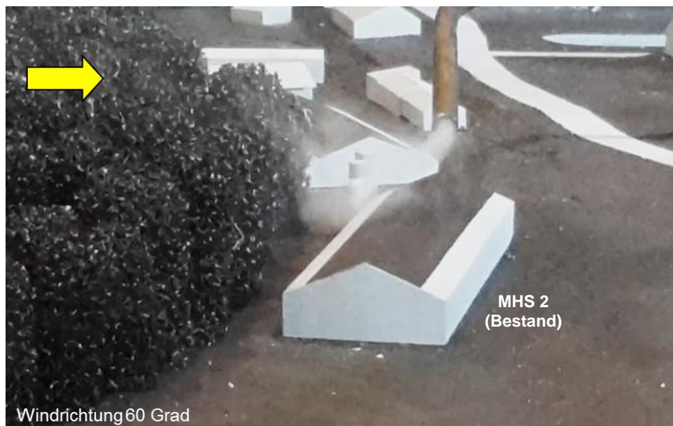
Abb. 4.4: Hügel mit Wald, Windrichtung 60 Grad: Strömungssichtbarmachung mittels Rauch im Bereich der Abgaskamine über dem First von Stall MHS 2 (Bestand). Zu einem anderen Zeitpunkt als in der Abbildung 4.3 auftretende Rückströmung hin zu dem bewaldeten Hang.
