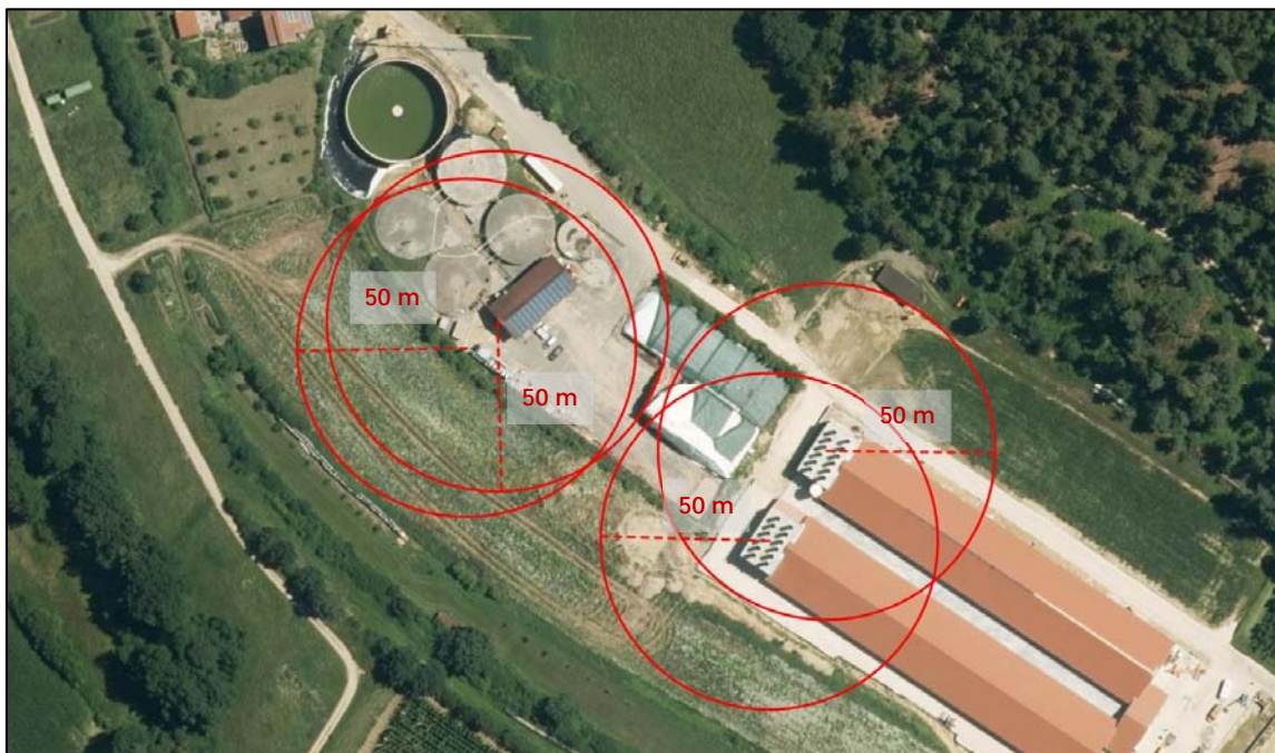
Abbildung 15 Luftbild mit Einzeichnung der maximalen Einwirkungsbereiche der Kaminanlagen von MHS 4, MHS 5 und BHKW-Module der Biogasanlage 2 mit den Radien 50 m
