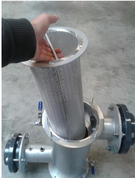
8) Prüfen Gummidichtungsring
