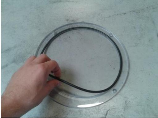
9) Installieren Schauglas und Dichtung
