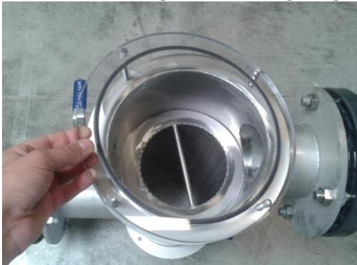
5) Entfernen Sieb aus Gehäuse
