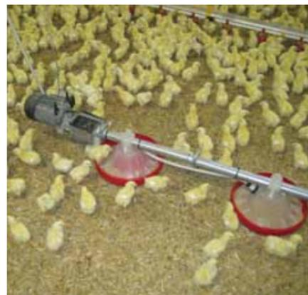
Antriebseinheit 0,37 kW (bzw. 0,55 kW) inkl. Endkontrollschale.
