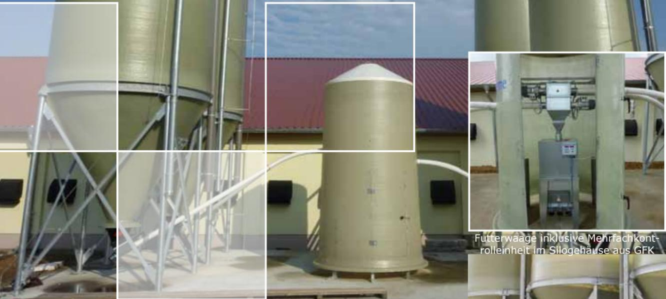
Futterwaage inklusive Mehrfachkontrollereinheit im Silogehäuse aus GFK
