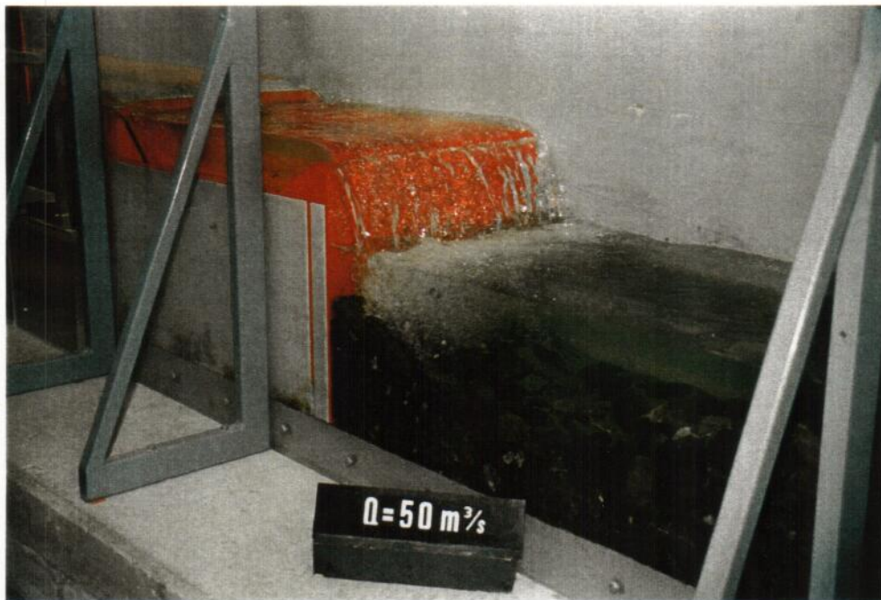
Nr. 17: Ausführungsvorschlag: Q = 50 \text{ m}^3/\text{s}
