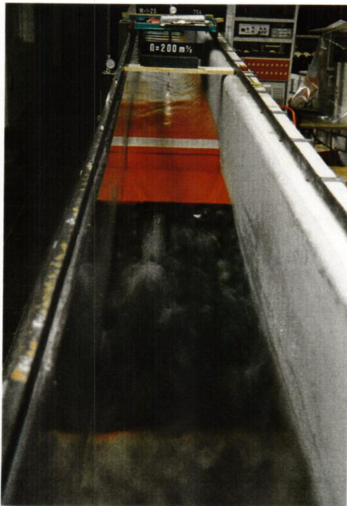
Nr. 9 und 10: Form A: rauhe Sohlrampe bei Q = 200 und 370 \text{ m}^3/\text{s}
