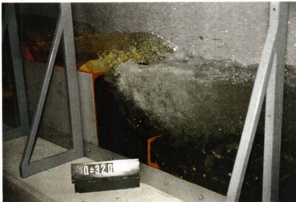
Bild 14: Form B: Mulde mit Schwelle
