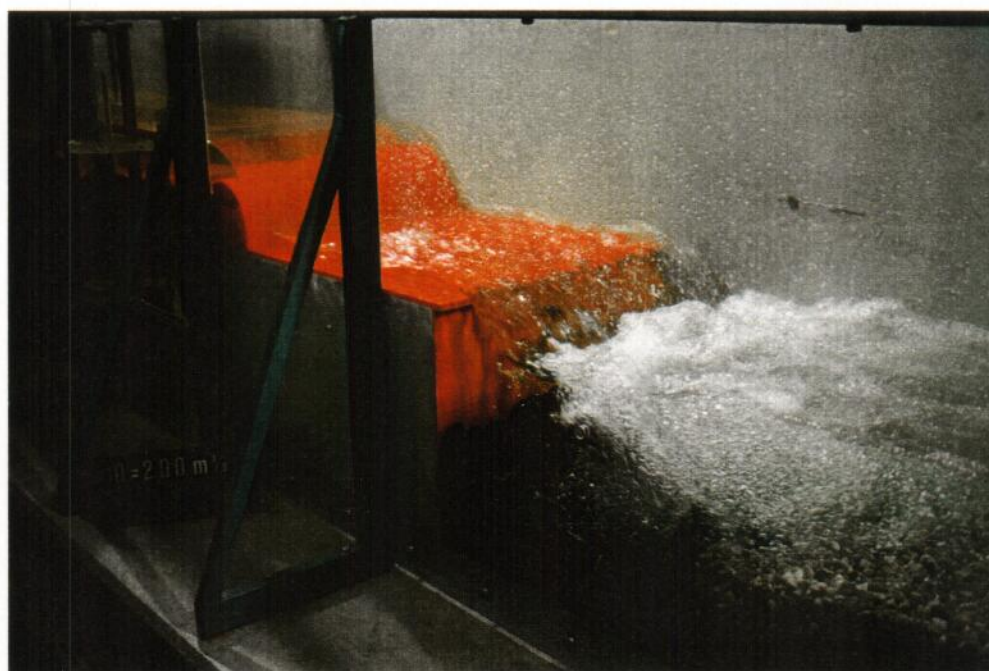
Nr. 5: Istzustand, Q = 200 \text{ m}^3/\text{s}
