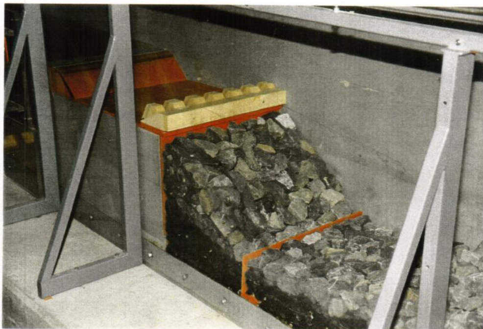
Nr. 12: Form C: Mulde mit Schwelle und Strahlteiler
