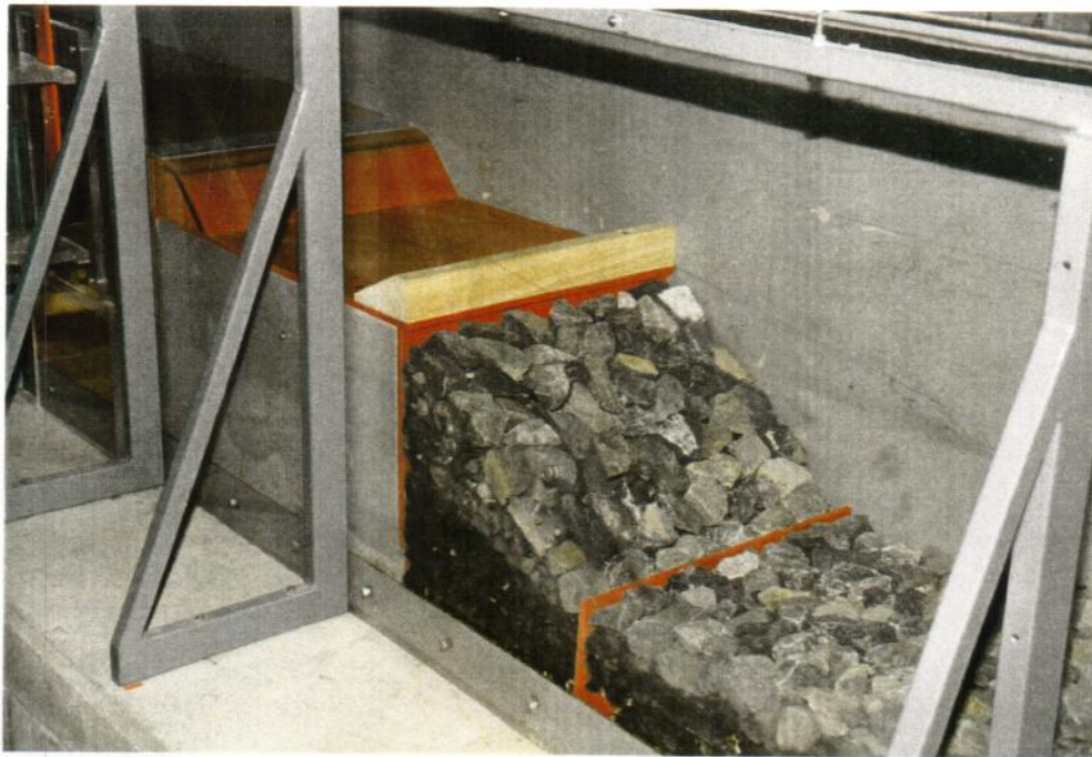
Nr. 11: Form B: Mulde mit Schwelle, Ansicht von der Seite
