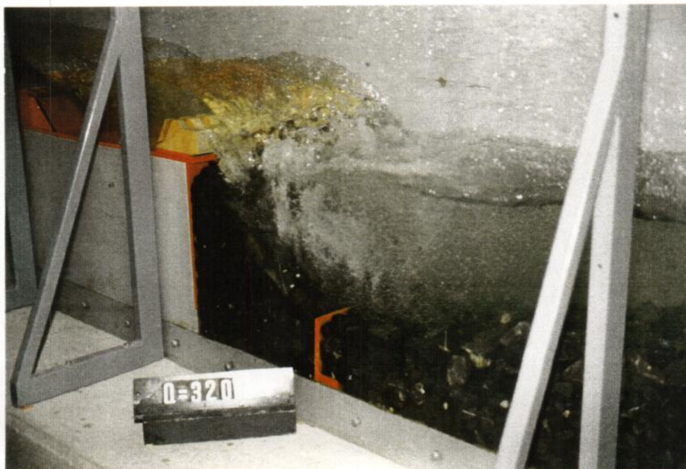
Bild 15: Form C: Mulde mit Schwelle und Strahlteiler
