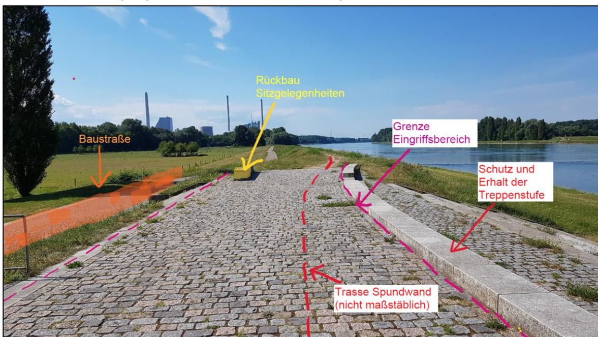
**Abbildung 9:** Skizzierung der geplanten Baumaßnahmen und des Eingriffsbereichs im Abschnitt der Rheinterrassen am Hofgut Maxau (Quelle: Anlage 2.1 zum Planfeststellungsantrag)
