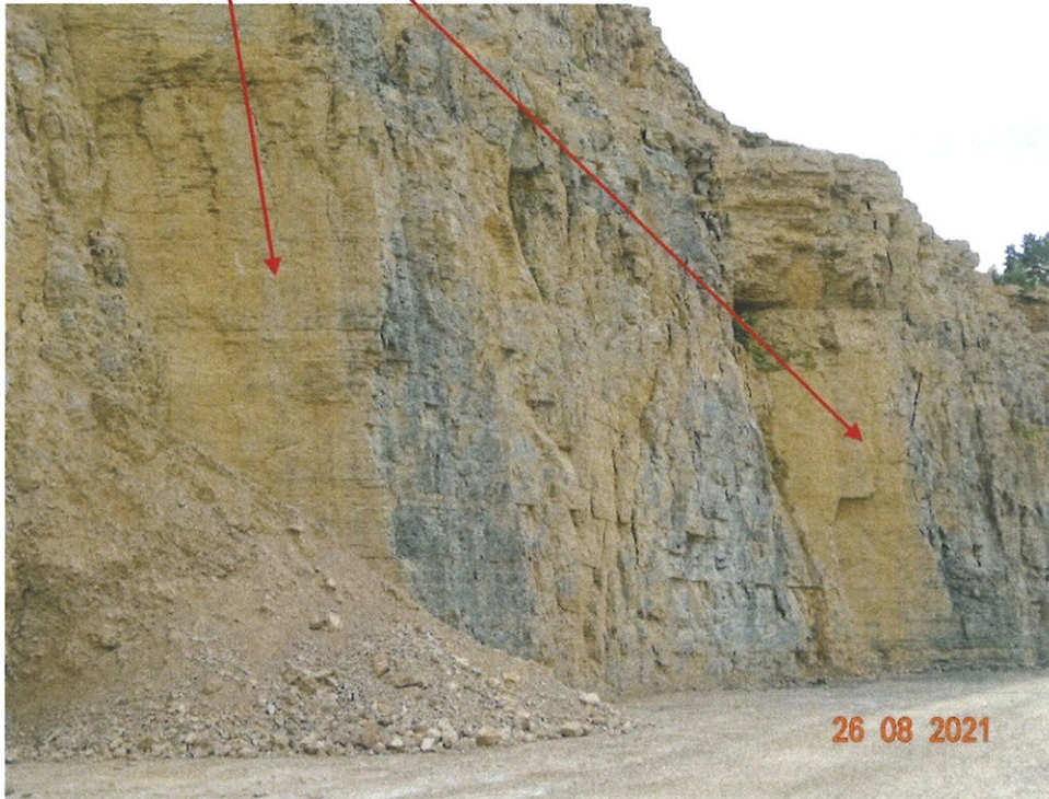
Foto 4: Blick auf die fast senkrecht einfallenden und ca. 60° streichenden Kluffflächen – Abbauwand Nord
