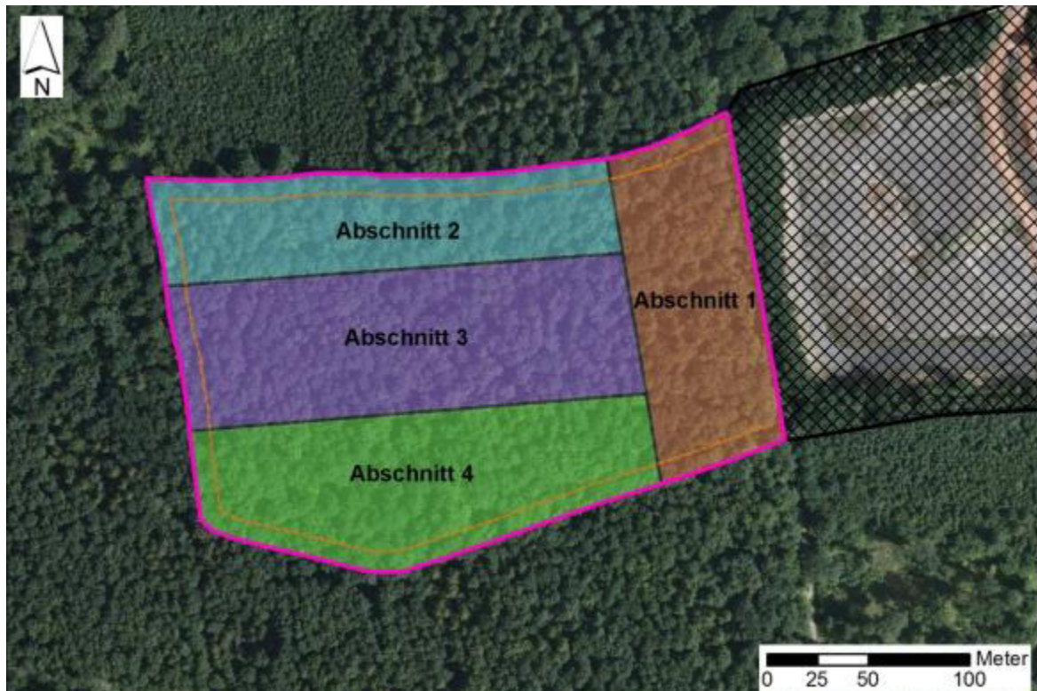
Abbildung 5: Abbauabschnitte (1 bis 4) der Erweiterungsfläche (pinke Umrandung: Erweiterungsfläche, beige Umrandung: Abbaufäche ohne Sicherheitsstreifen, schwarze Kreuzschraffur: Resttonflächen in der bestehenden Tongrube)
