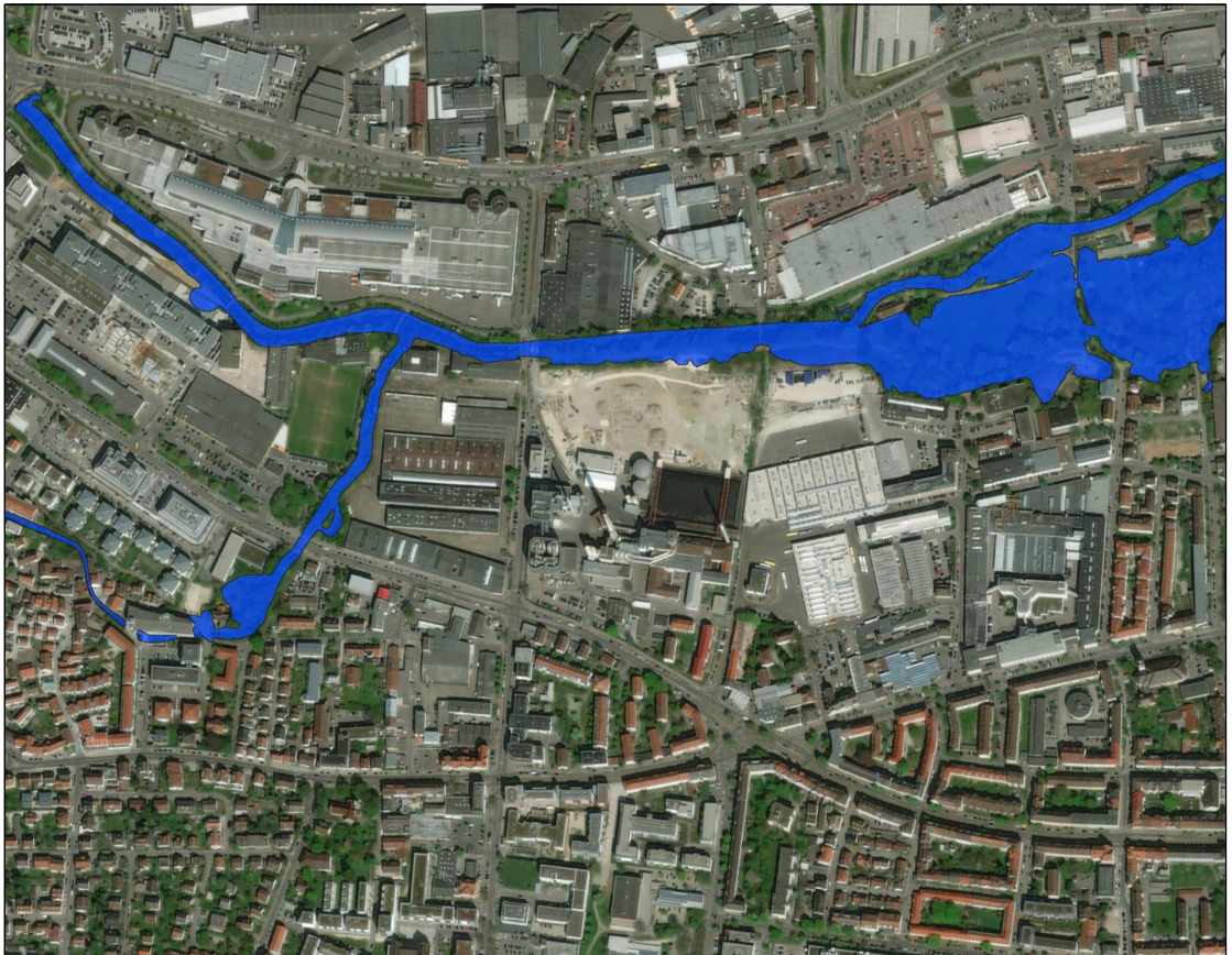
Abbildung 15. Hochwassergefahrenbereiche (HQ 100 ) im Nahbereich des HKW Ulm
