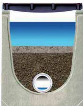
Abbildung 2: Filtersubstratrinne DN 400 (Aufbau)
