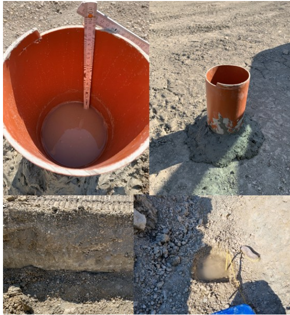
Abb. 23: Darstellung des Versuchsaufbaus zur Ermittlung der Versickerungsraten in verschiedenen Bereichen des Steinbruchs (Abbausohlen, Fahrwege, Impressamergel und Rekultivierungsschichten) (Bild: Fa. Dr. Köhler & Dr. Pommerening).
