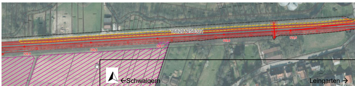
Abb. 8: Darstellung des Eingriffs in das geschützte Biotop „Feldhecke an den „Schalkwiesen“ S Schluchtern“ (BT Nr. 168201250321) hier der östliche Bereich, dargestellt mit gelber Umrandung) (rot dargestellt: technische Planung, Schwarz dargestellt: Planfeststellungsgrenze, lila dargestellt: BE-Fläche)
