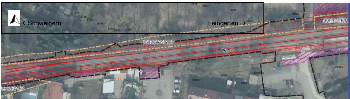
Abb. 12: Darstellung des Eingriffs in das geschützte Biotop „Feldhecken der Bahntrassen östlich von Schwaigern“ (BT Nr. 168201250187) hier der mittlere Bereich, dargestellt mit oranger Umrandung) (rot dargestellt: technische Planung, Schwarz dargestellt: Planfeststellungsgrenze, Lilla dargestellt: BE-Flächen)
