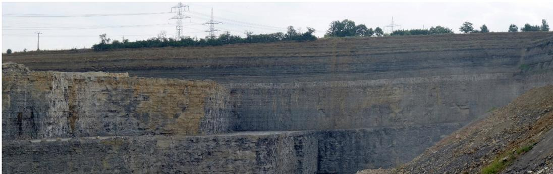
**Abb. 1:** Übersichtsaufnahme der östlichen Abbauwand vom 12.07.2018. Im Süden (im Bild rechterhand) ist das Schichteinfallen noch etwas steiler und verflacht nach Norden zunehmend. Bei dem helleren Band in der Abbauwand im Niveau der obersten Abbausohle handelt es sich um die Schichten des Trigonodusdolomits.
