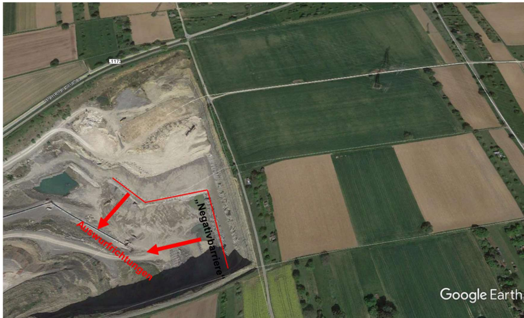
Abb. 4: Prinzip des derzeitigen und zukünftigen Abbaus nach dem Prinzip der „Negativbarriere“.
