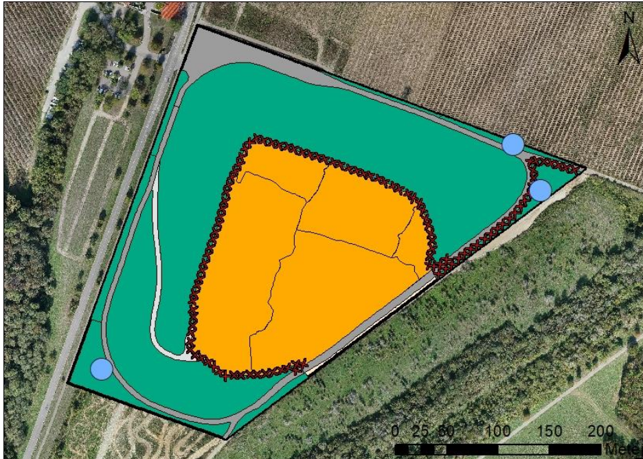
Abbildung 6-1.4. Zaunverlauf im Bereich des bereits rekultivierten Bereichs (dunkelgrün), weiterhin Zäunung des Bereichs mit Versickerungsbecken (aktiver Deponiebereich orange).
