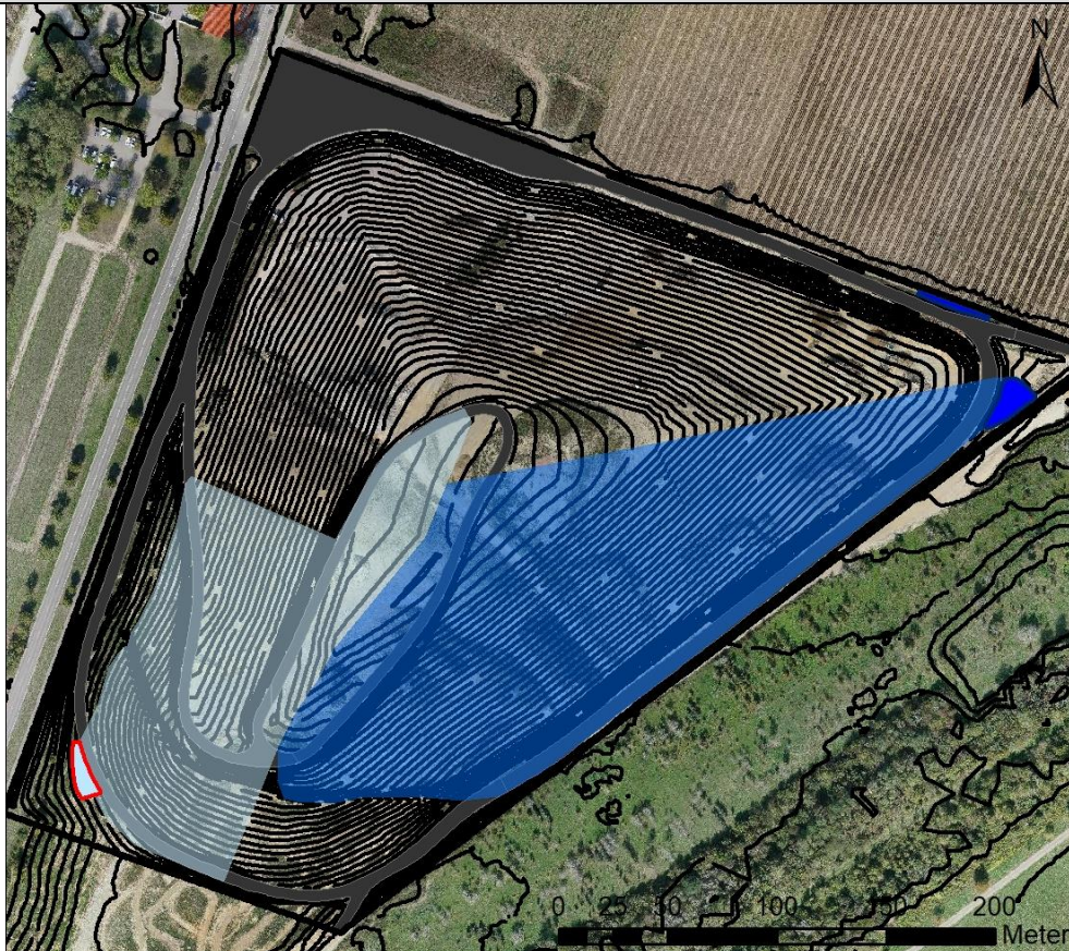
Abbildung 6-2.2. Geplante Tümpel mit zugehörigen Einzugsgebieten (hellblau: Tümpel im Randwall, hellblau transparent: zugehöriges Einzugsgebiet; dunkelblau: Tümpel im Südteil des Versickerungsbeckens im Nordostteil des Deponiegeländes sowie Überlauf, dunkelblau transparent: zugehöriges Einzugsgebiet).
