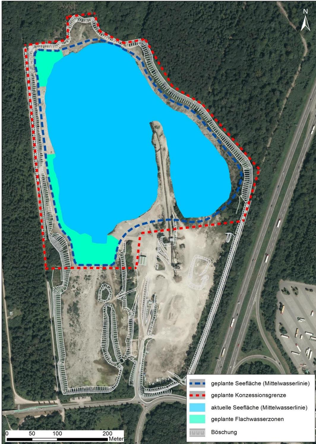
**Abbildung 3.1-1.** Derzeitige Seefläche, geplante Seefläche bei Mittelwasser, geplante Flachwasserzonen sowie geplante Konzessionsgrenze.
