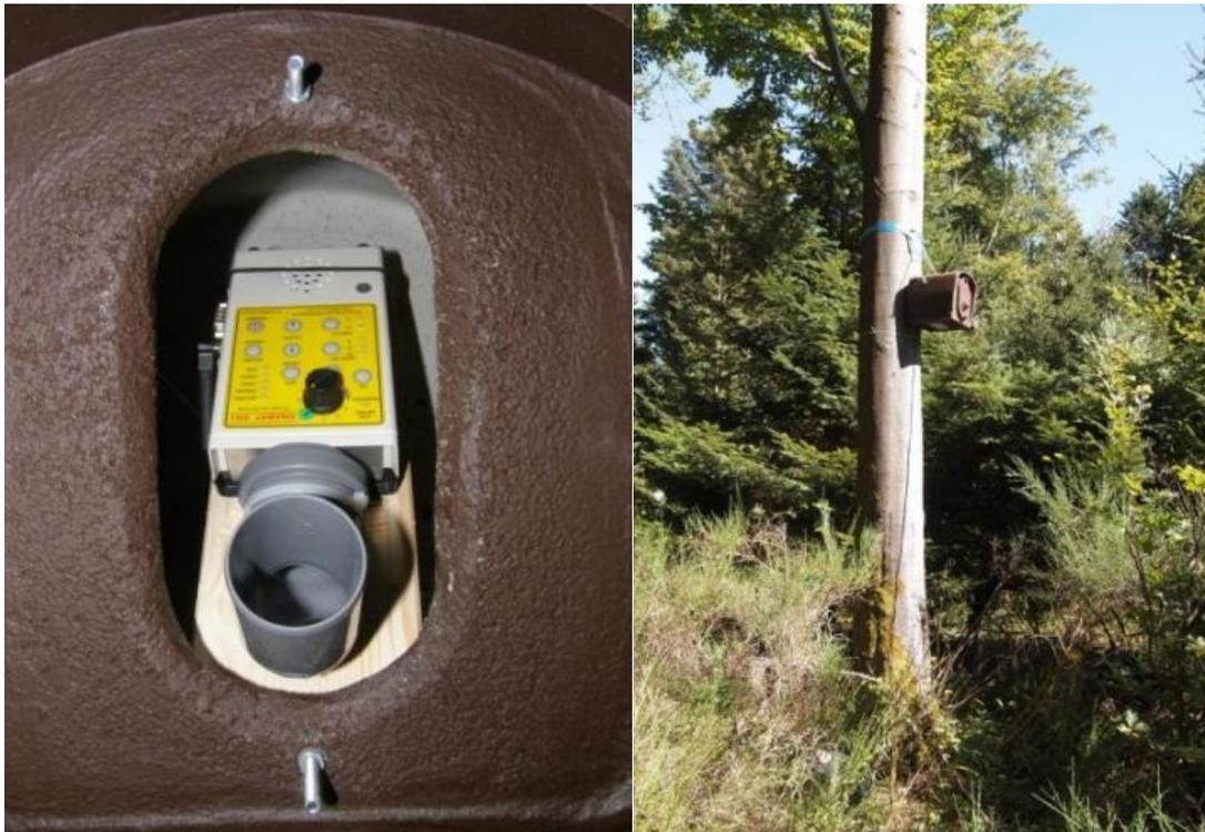
**Abb. 3:** Detailansicht des Aufnahmesystems installiert in der Dohlennisthöhle und am Baum angebrachtes Aufnahmesystem (hier am Anabat-Standort 2).
