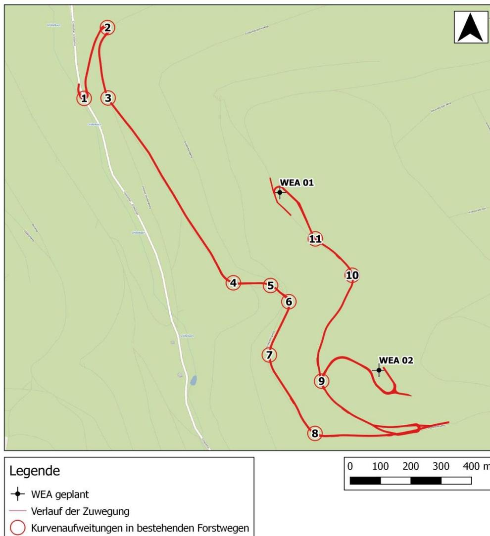
Abb. 4: Verlauf der geplanten Zuwegung und Kurvenbereiche in bestehenden Forstwegen mit Nummerierung.<sup>4</sup>
