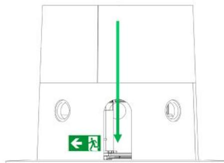
Abbildung 5 - Schematische Rettungswegführung aus der Gondel/
