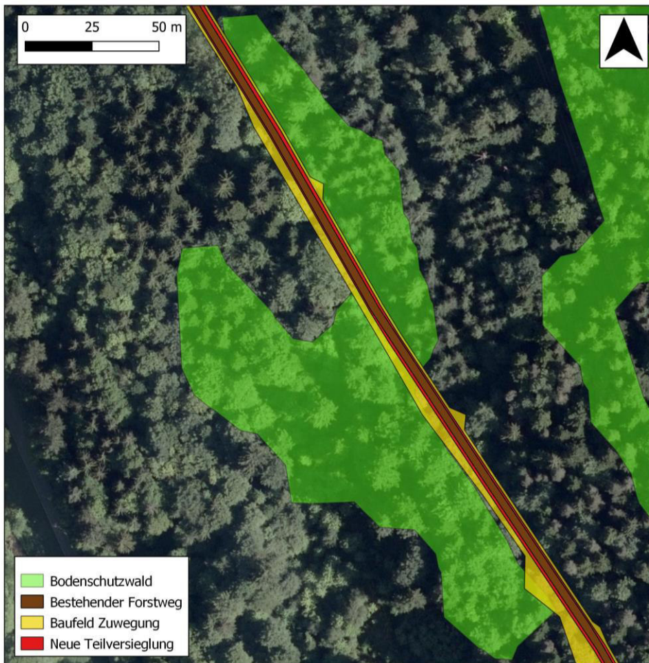
Abb. 2: Eingriff in den Bodenschutzwald entlang der Zuwegung. 3
