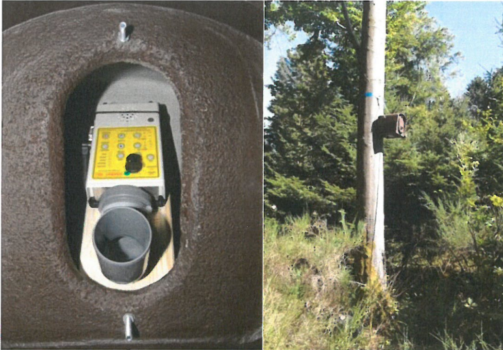
Abb. 2: Detailansicht des Aufnahmesystems installiert in der Dohlennisthöhle und am Baum angebrachtes Aufnahmesystem (hier am Anabat-Standort 2).
