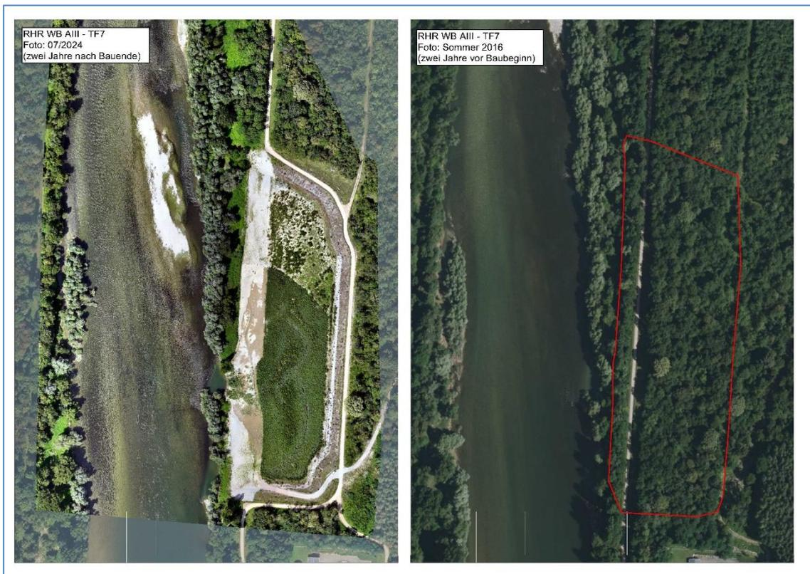
**Abb. 4.4.18:** Rückhalterraum Weil-Breisach Abschnitt III TF7; gewässermorphologische Entwicklungen nach Tieferlegung (linkes Bild Fläche nach Abtrag, rechtes Bild Situation vor Geländetieferlegung)
