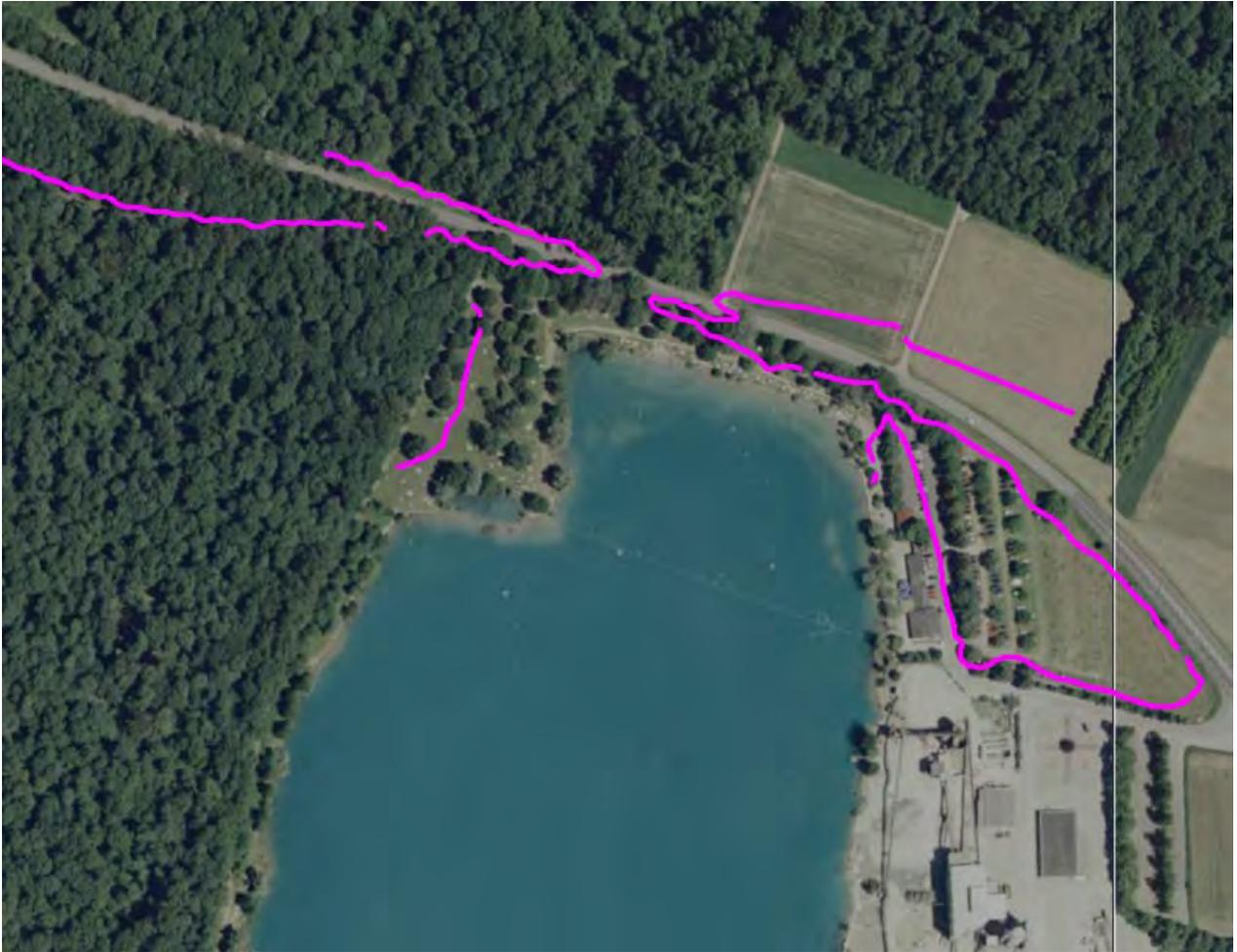
*Abbildung 5: Magenta = Höhen 158,9 m üNN nördlich und südlich der Kreisstraße, die bei extremem HW theoretisch überschwemmt sind*
