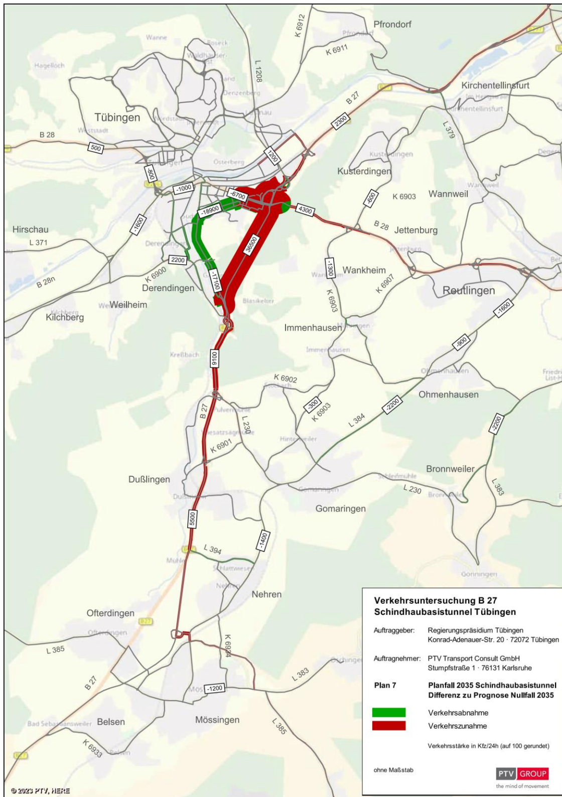
Abb. A2.6: Lageplan des Untersuchungsgebiets aus dem Verkehrsgutachten mit Zunahmen (rot) und Abnahmen (grün) des Kfz-Verkehrs in Kfz/24h.
