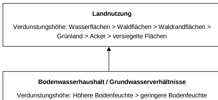
Abb. 7: Abhängigkeit der realen Verdunstung von Landnutzung und Bodenfeuchte
