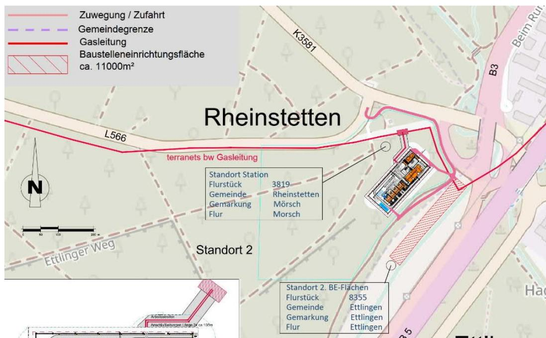
**Abb. 1: Geplante Lage der Verdichterstation, der Zuwegungen und der Baustelleneinrichtungsfläche (UNIPER 2019)**
