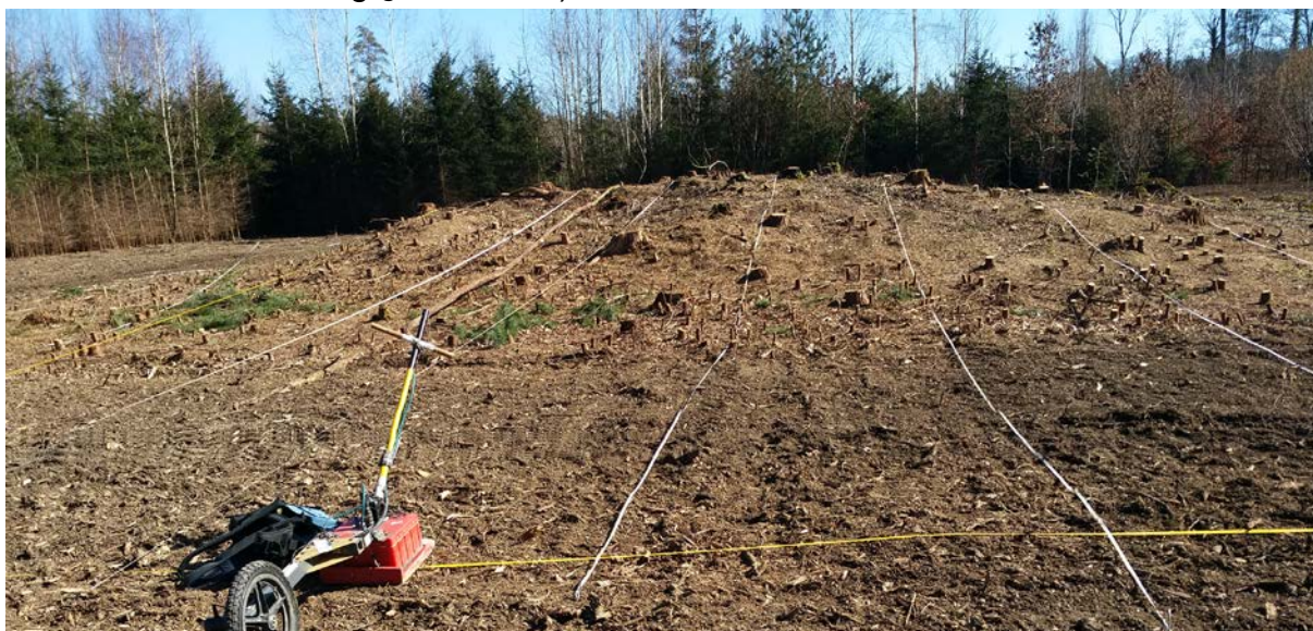
Georadarmessung auf dem abgeholzten Grabhügel und in dessen Umfeld (Foto: GGH, Christian Hübner)
