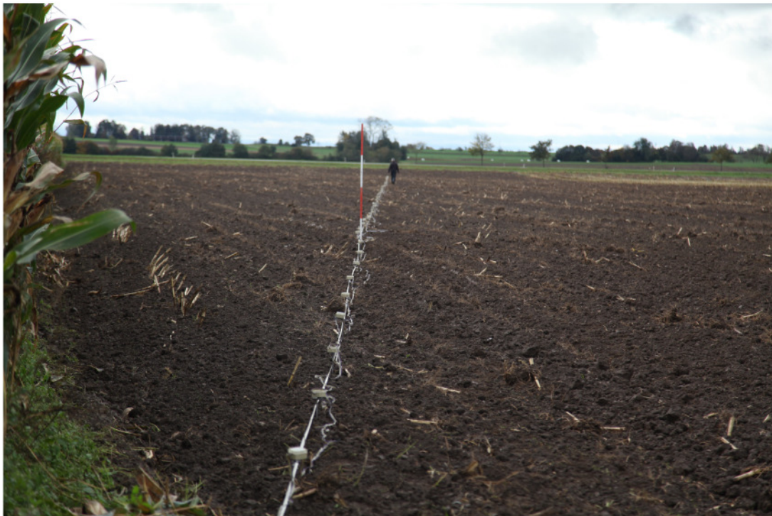
Abbildung 1: Geoelektrisches Tomographieprofil mit Multielektrodenkette.
