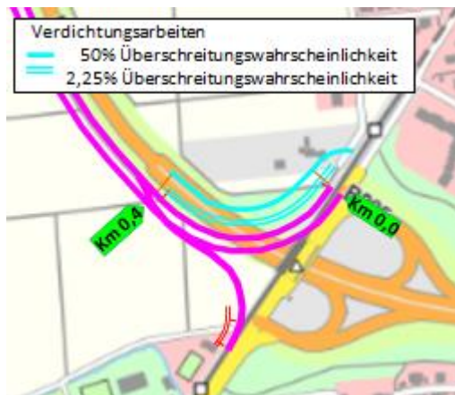
Abbildung 2: Bereiche in denen seitlich der Trasse Erschütterungsimmissionen aus Arbeiten zur Bodenverdichtung erwartet werden km 0 – km 0,4
