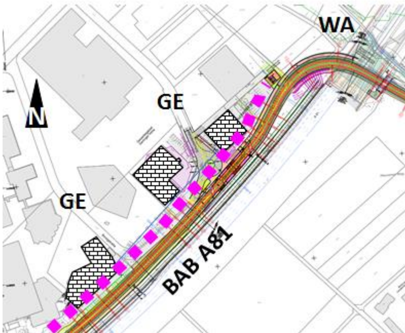
Abbildung 19: Lageplan Bereich Messort 6 (Gewerbegebiet Ditzingen-Ost); violett gepunktete Linie zeigt den Abstand, für den in einem Wohnhaus ein KB_{Fmax} -Wert von 0,1 (Fühlgrenze) prognostiziert würde
