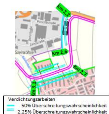
Abbildung 3: Bereiche in denen seitlich der Trasse Erschütterungsimmissionen aus Arbeiten zur Bodenverdichtung erwartet werden km 2,2 – km 2,6 und km 2,7 bis km 3,1
