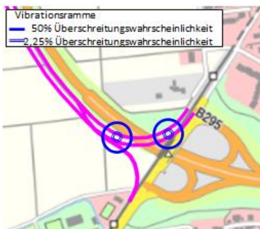
Abbildung 6: Bereiche in denen durch Einsatz von Vibrationsrammen Erschütterungs- immissionen erwartet werden; Brückenköpfe bei km 0,1
