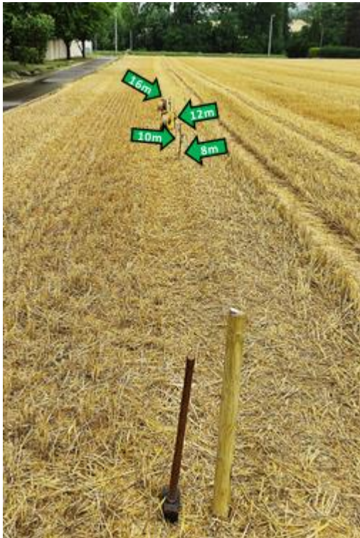
Abbildung 4: Eine Seite eines Messquerschnittes; im Vordergrund Holzpflock und Hammer
