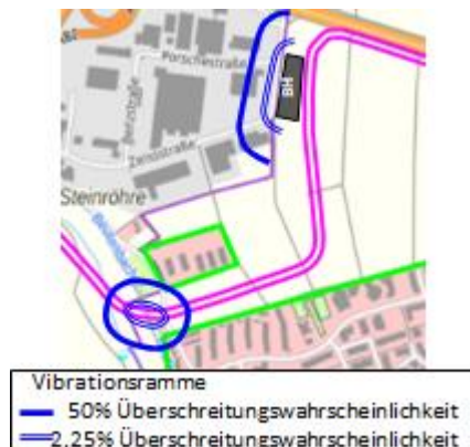
Abbildung 7: Bereiche in denen durch Einsatz von Vibrationsrammen Erschütterungs- immissionen erwartet werden; Brückenköpfe bei km 3,1; Baugrube des Betriebshofes
