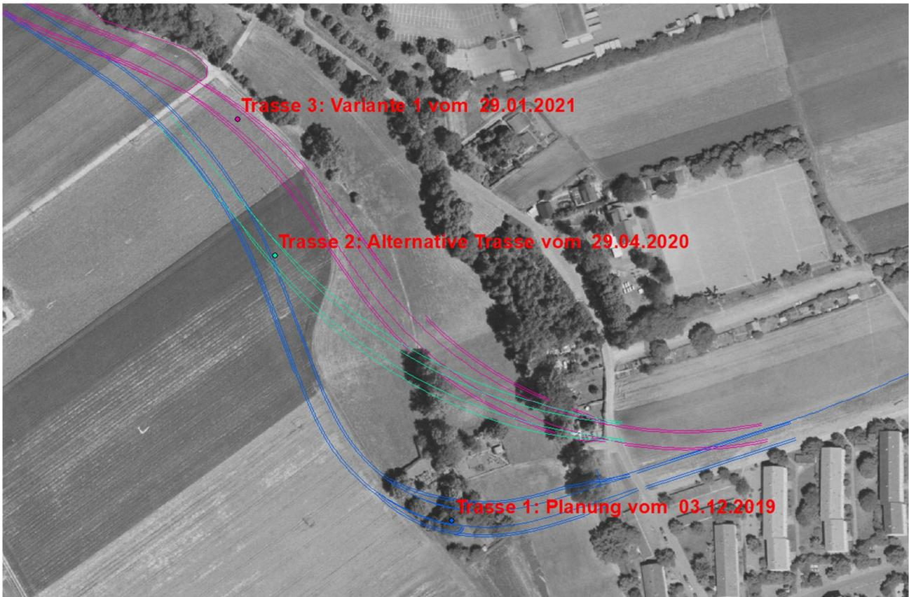
Abbildung 7: Varianten Trassenführung
