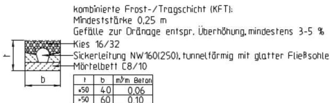
Abbildung 3: Regelzeichnung Gleisdrainage, SSB AG
