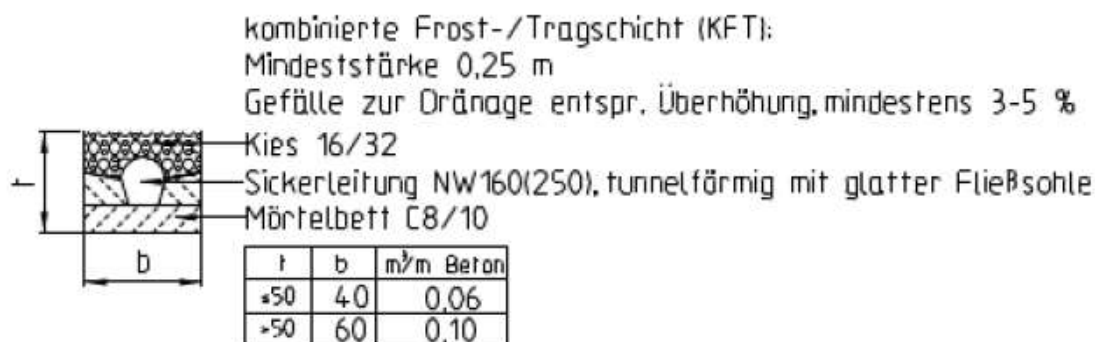
Abbildung 2: Regelzeichnung Gleisdrainage, SSB AG
