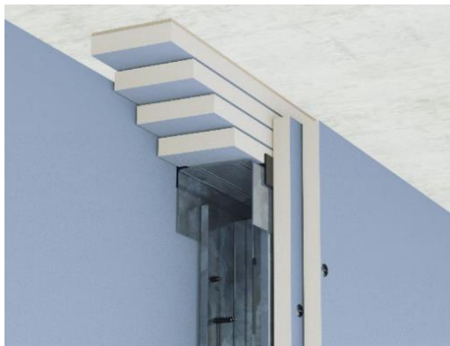
Abbildung 12. Gleitender Anschluss der Gipskartonständerwand an die Decke.
