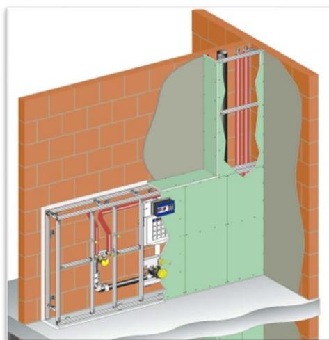
Abbildung 20: Leichtbauinstallationssystem (Quelle ZVSHK)
