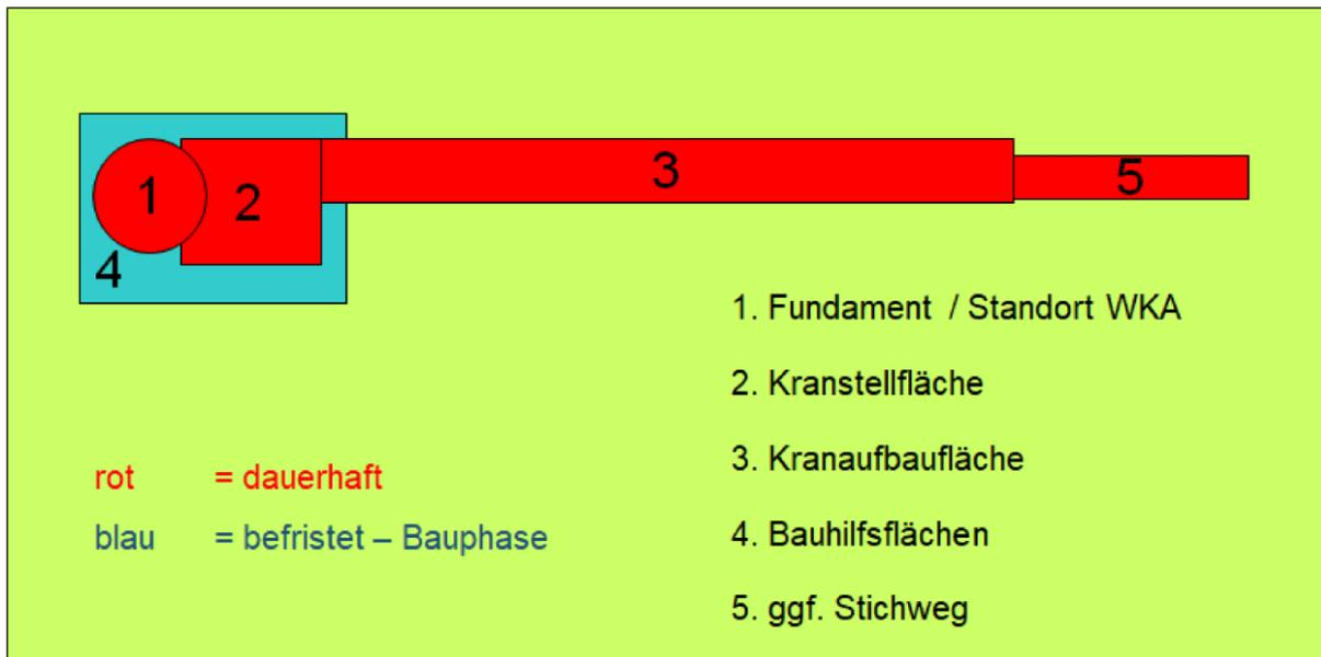
**Abbildung 4-23:** Schematische Einteilung der dauerhaft/befristeten Waldumwandlung gemäß §§ 9,11 LWaldG (Variante B) durch Windenergieanlagen (REGIERUNGSPRÄSIDIUM FREIBURG, Abt. 8, Stand 17.01.2024)
