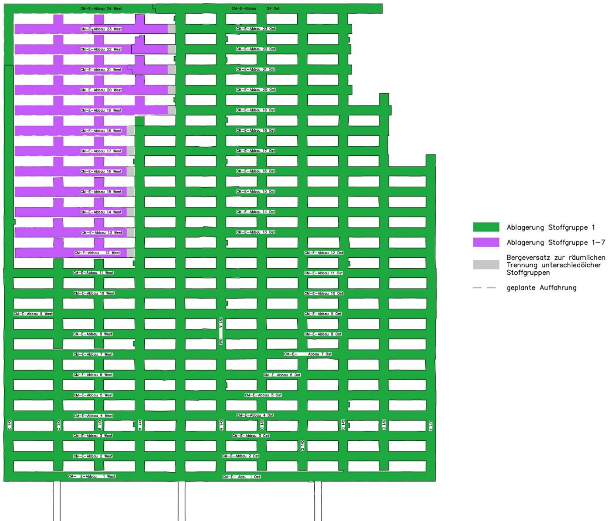
Abbildung 11: Untertagedeponie nach Abschluss der Ablagerungsphase (siehe auch Anlage C-8.4)
