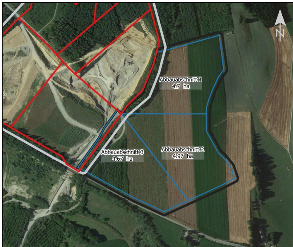
Abbildung 2 – Abbauschritte der Erweiterungsfläche 1
