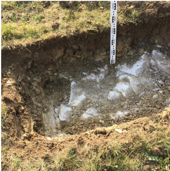
Abbildung 5: Beispielhaftes Bodenprofil mit anstehendem Verwitterungshorizont (Quelle: Ingenieurgesellschaft für Geo+Energie+Umwelt, 2019)
