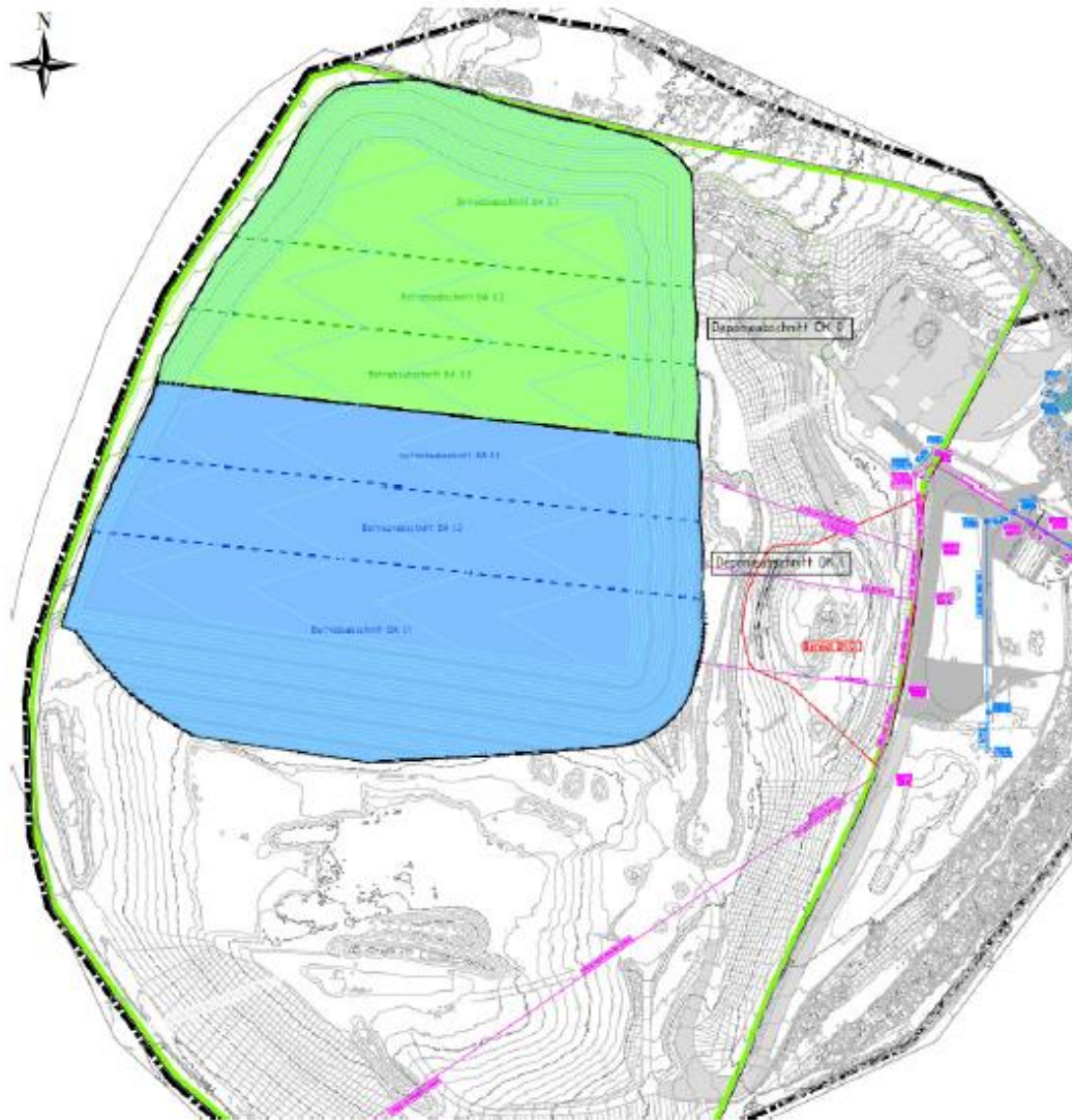
Abbildung 2: Lageplan mit Darstellung der geplanten Ablagerungsflächen DK 0 (grün) und DK I (blau) (unmaßstäblich, Sweco, 2019)
