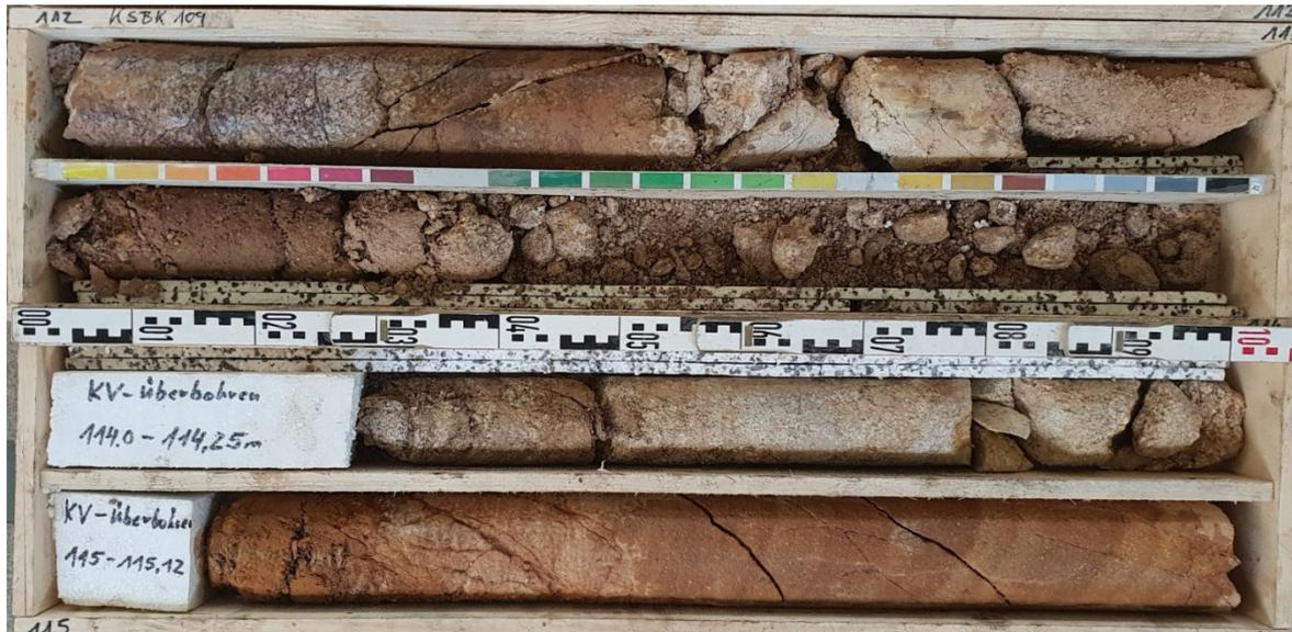
**Abb. 5:** Bohrkern aus der KS BK 109, bei 112 m Tiefe mit vergrustem Forbach-Granit G4, w3 bis w4.
