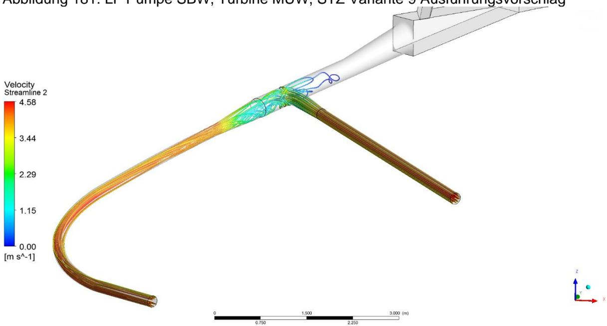
Abbildung 182: LF Pumpe SBW, Turbine MUW, ASZ Variante 9 Ausführungsvorschlag
