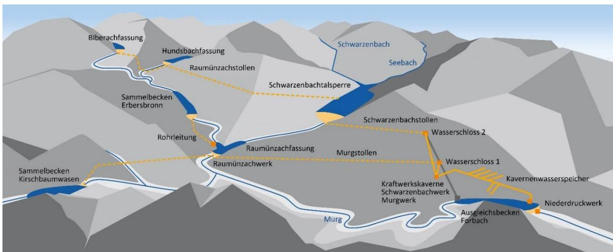
**Abbildung 2: Übersichtsdarstellung des Vorhabens PSW Forbach – Neue Unterstufe**
