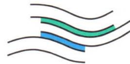
Wir schlagen als Dammbaumaterial z.B. Löss, Lösslehm und Verwitterungslehm vor, die in der Umgebung beim Baugrubenaushub anfallen. Dieses Material kann auf Mieten zwischengelagert und mit Folien abgedeckt werden, um eine zu starke nachträgliche Durchfeuchtung der Böden zu verhindern. Vorher muss die Eignung des Materials mittels Proctorversuchen überprüft werden. Kurz vor und während des Einbaues müssen die Wassergehalte kontrolliert werden.
