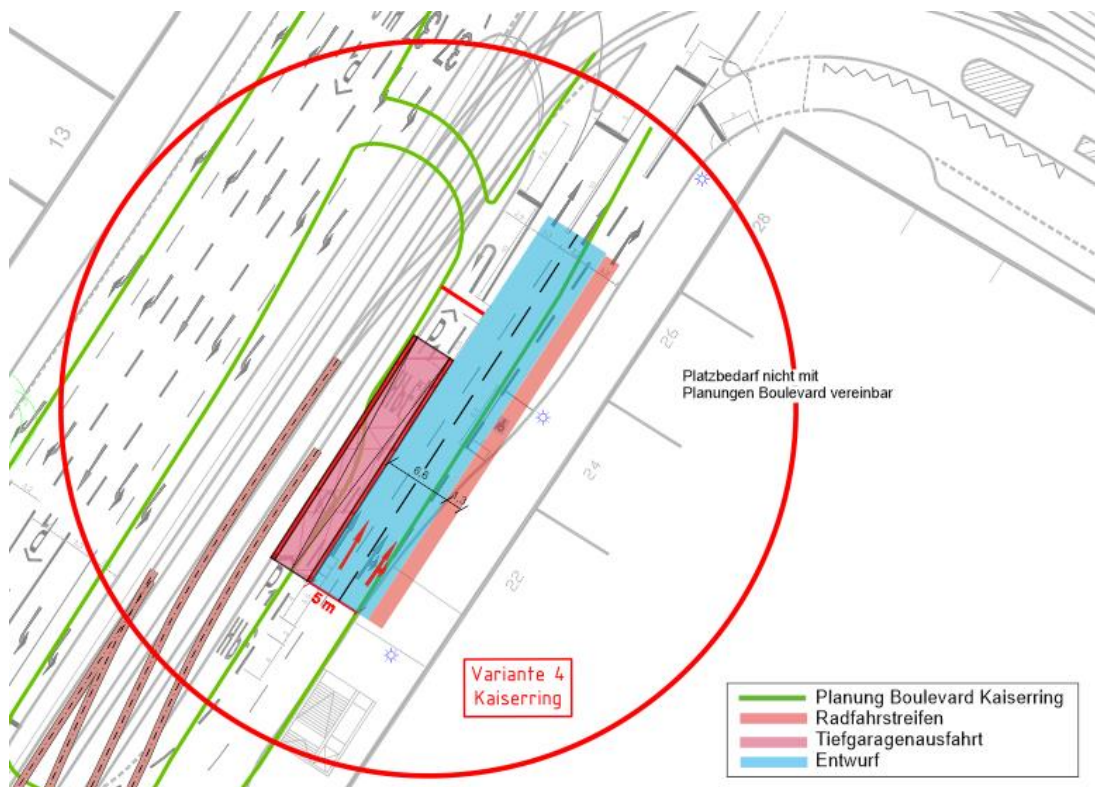
Abbildung 15: Anbindung der Tiefgaragenausfahrt an den Kaiserring.; Variante 4
