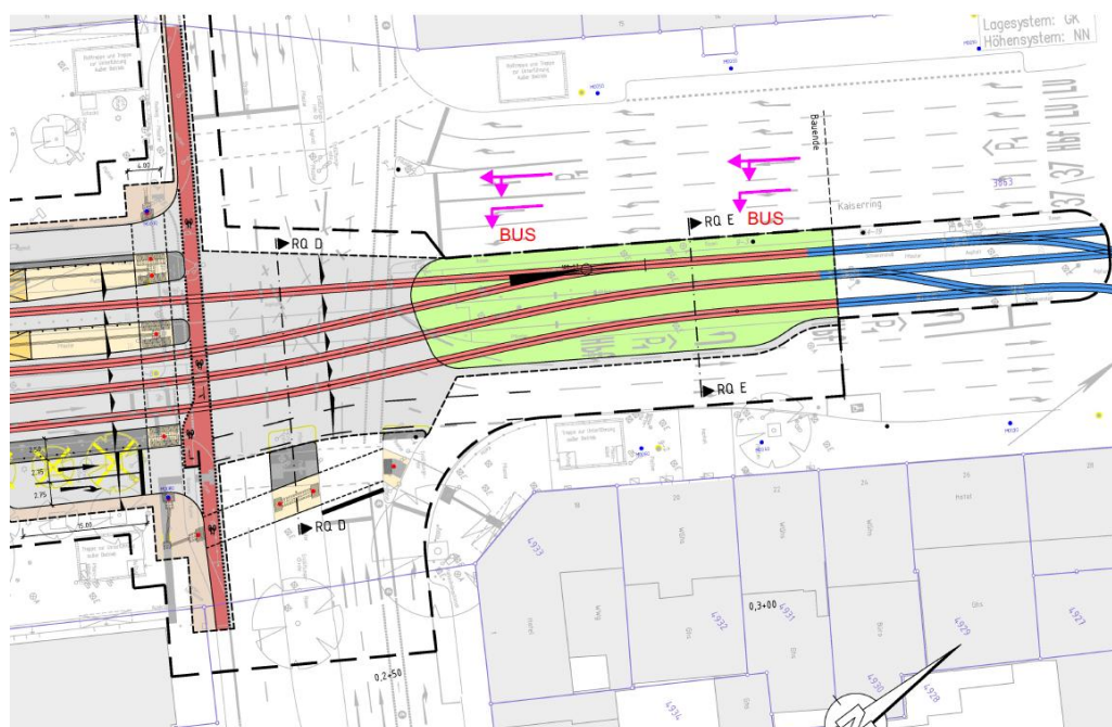
Abbildung 6: Knotenpunktkonzept c – Busverkehr links als separate Busspur (Quelle: mrv)
