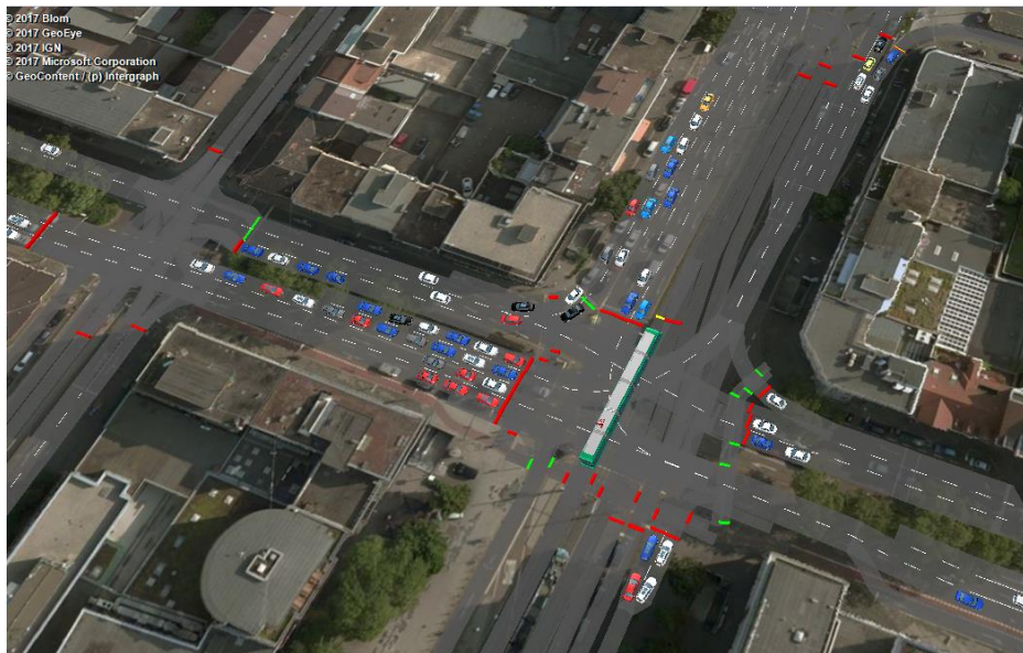
Abbildung 17: Verkehrsablauf am Knotenpunkt Bismarckstr./Kaiserring bei Überfahrt einer Bahn aus Richtung Kunsthalle/Tattersall
