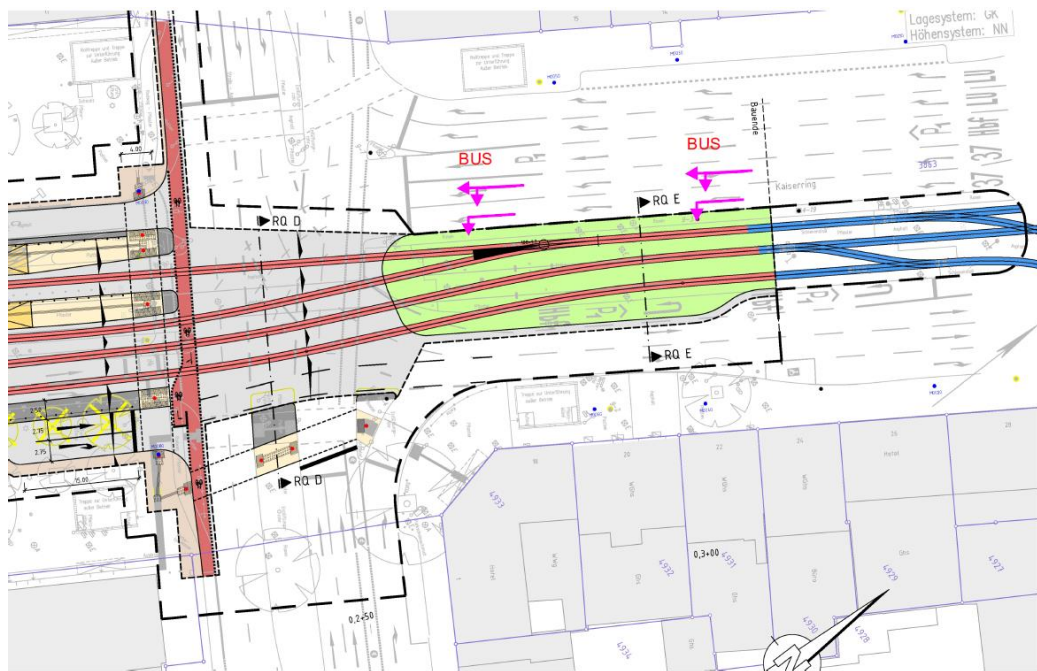
Abbildung 5: Knotenpunktconcept b – Busverkehr mittig als separate Busspur (Quelle: rnv)
