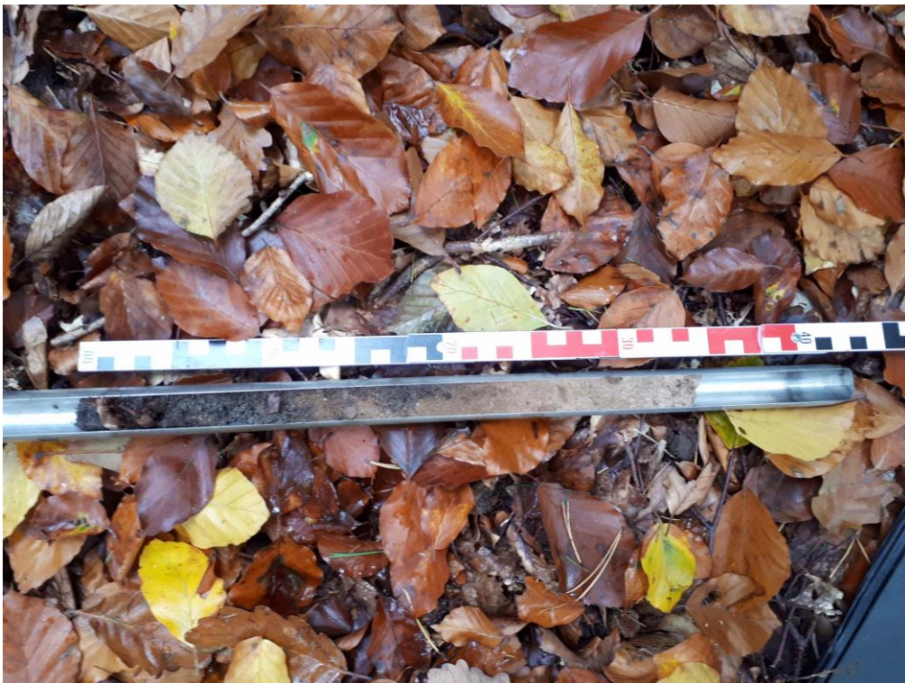
Abbildung 4: Pürckhauer – Handbohrung S1, im unteren Bereich Kernverlust
