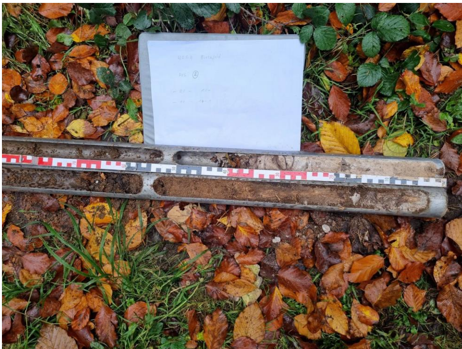
Abbildung 8: Kleinrammbohrung RKS 2, 0,0-1,4 m u. GOK (Baugrundbohrung); Hier ist die Horizontabfolge von Streuauflage, zu A-Horizont (Ae) erkennbar. Darunter folgt der B-Horizont, der schließlich in den C-Horizont übergeht.
