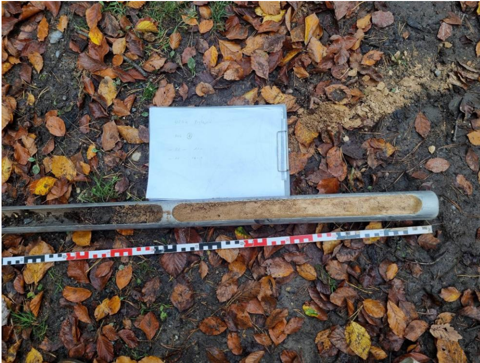
Abbildung 7: Kleinrammbohrung RKS 1, 0,0-2,3 m u. GOK; nicht bodenkundlich aufgenommen, da Bohrung aus dem Baugrund. Dennoch ist die Streuauflage sowie der O-Horizont bis ca. 0,1 m u. GOK erkennbar. Darunter folgt der Ae-Horizont, der schließlich in den B-Horizont übergeht. Der C-Horizont steht ganz am Ende der Bohrung an
