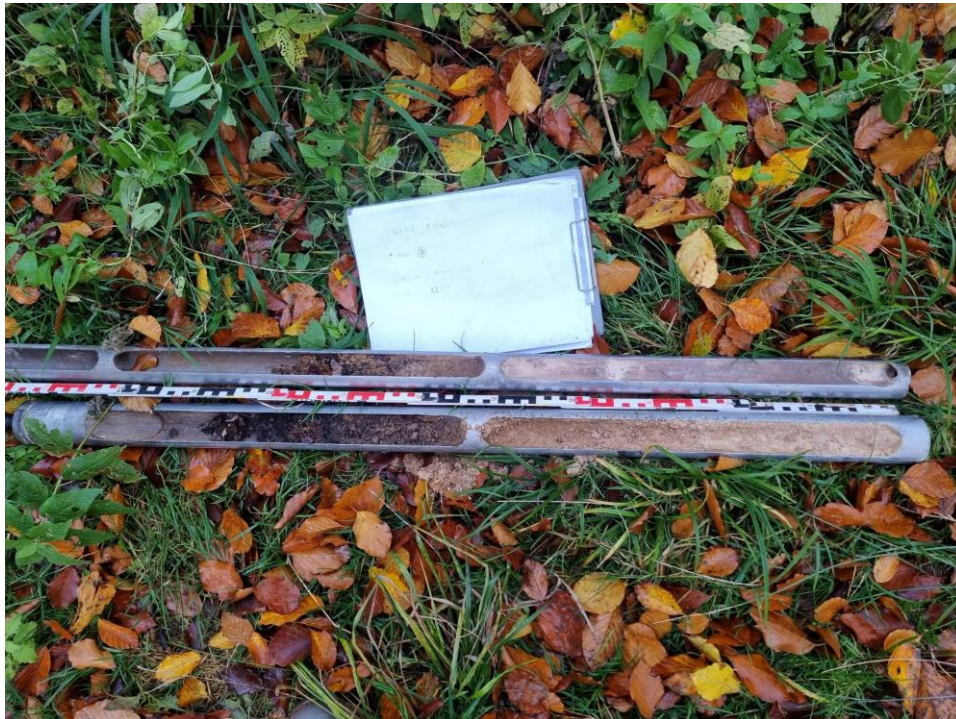
Abbildung 9: Kleinrammbohrung RKS 3, 0,0-2,2 m u. GOK; (Baugrundbohrung, nicht bodenkundlich aufgenommen); Streuauflage sowie der O-Horizont bis ca. 0,2 m u. GOK gut erkennbar. Darunter folgt der Ae-Horizont. Am Ende des Ae-Horizontes ist ein Bs-Horizont erkennbar, der in einen Bv-Horizont übergeht, bevor der C-Horizont auftritt.
