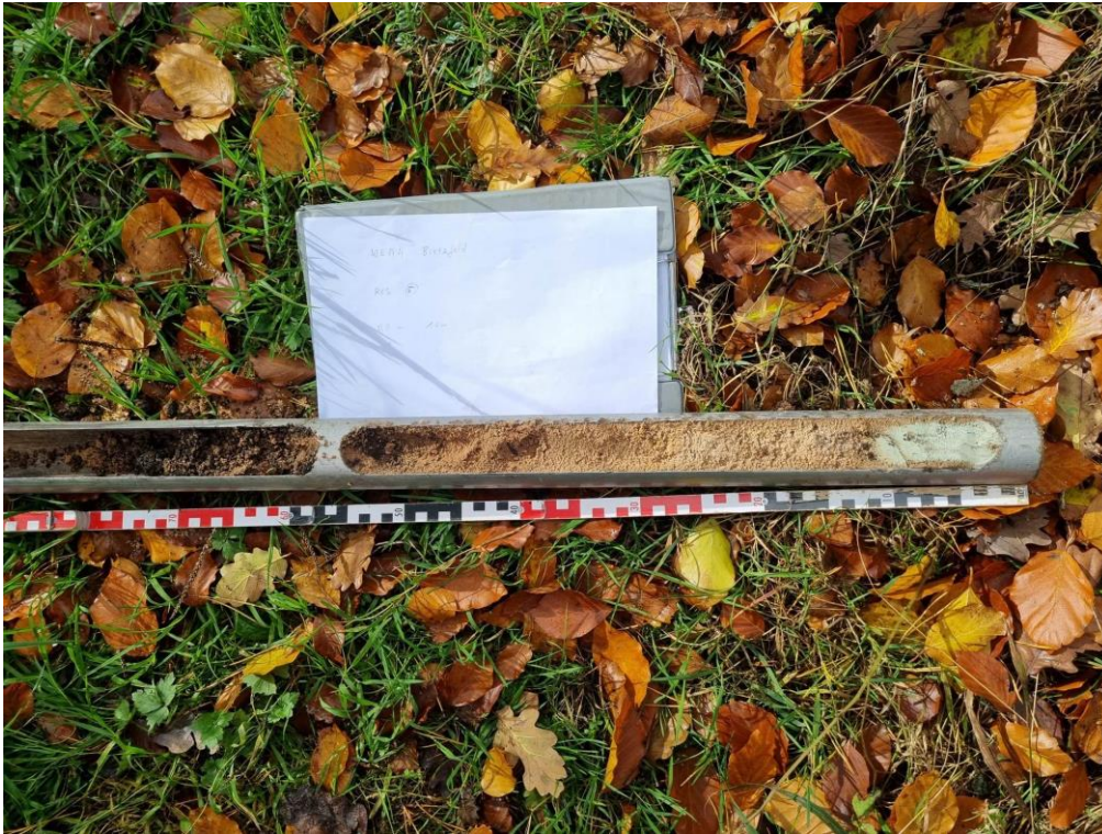
Abbildung 11: Kleinrammbohrung RKS 5, 0,0-2,3 m u. GOK; (Baugrundbohrung); Hier ist die Horizontabfolge von Streuauflage, zu A-Horizont (Ae) erkennbar. Darunter folgt der Bv-Horizont. Auf den letzten 15 cm der Bohrung ist der C-Horizont erkennbar.
