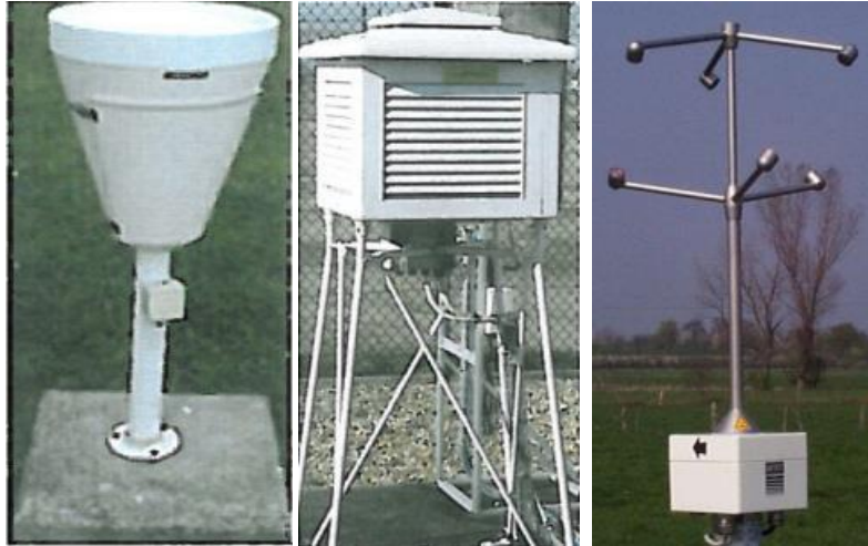
Beispiele von Geräten für Niederschlags-, Temperatur- und Windmessungen © EDF
