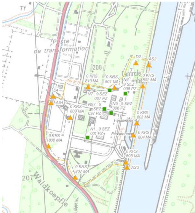
Figure 8.n Emplacement des balises de mesure du débit de dose gamma ambiant en clôture du site de Fessenheim
