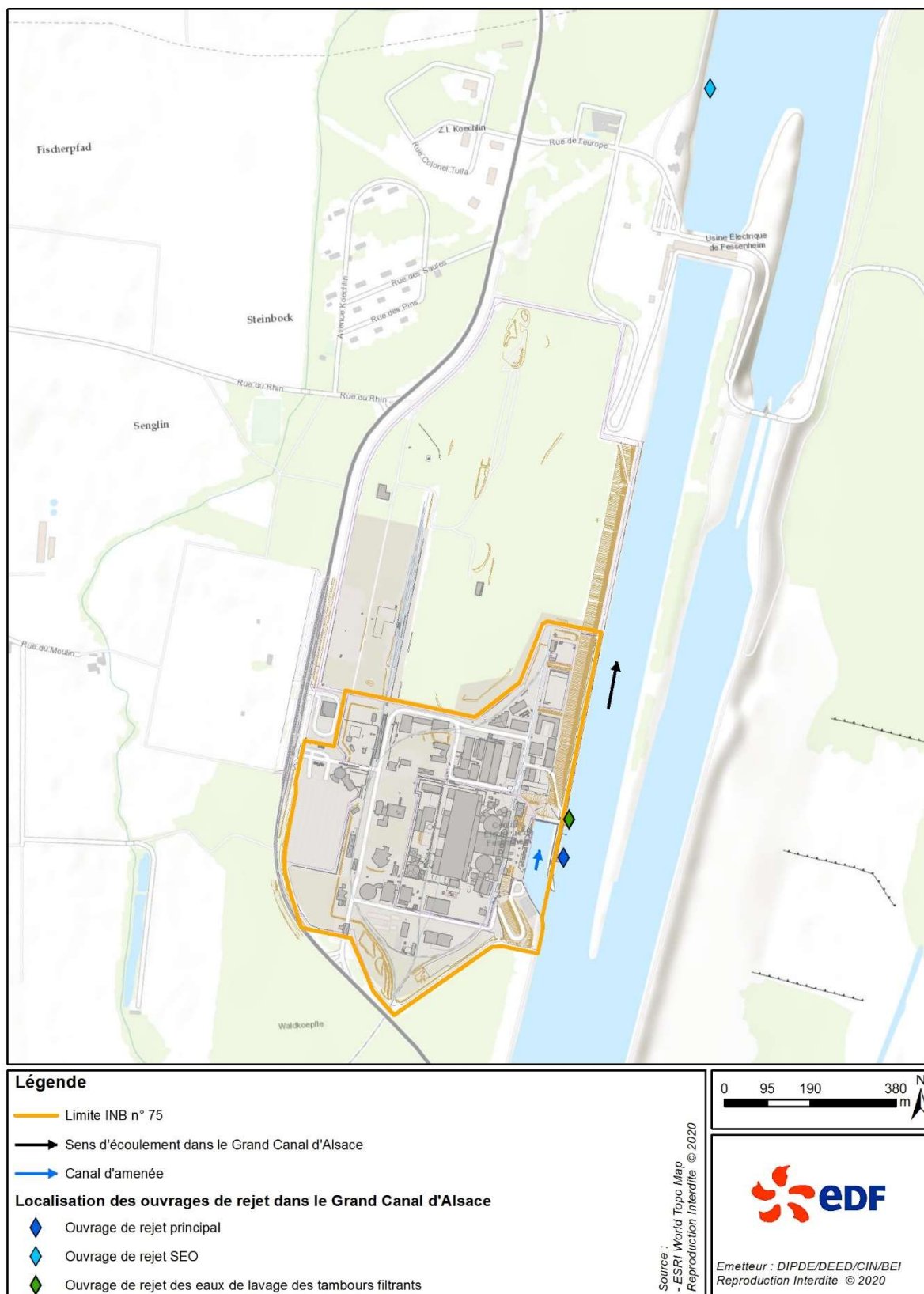
Figure 2.r Implantation des ouvrages de rejet
