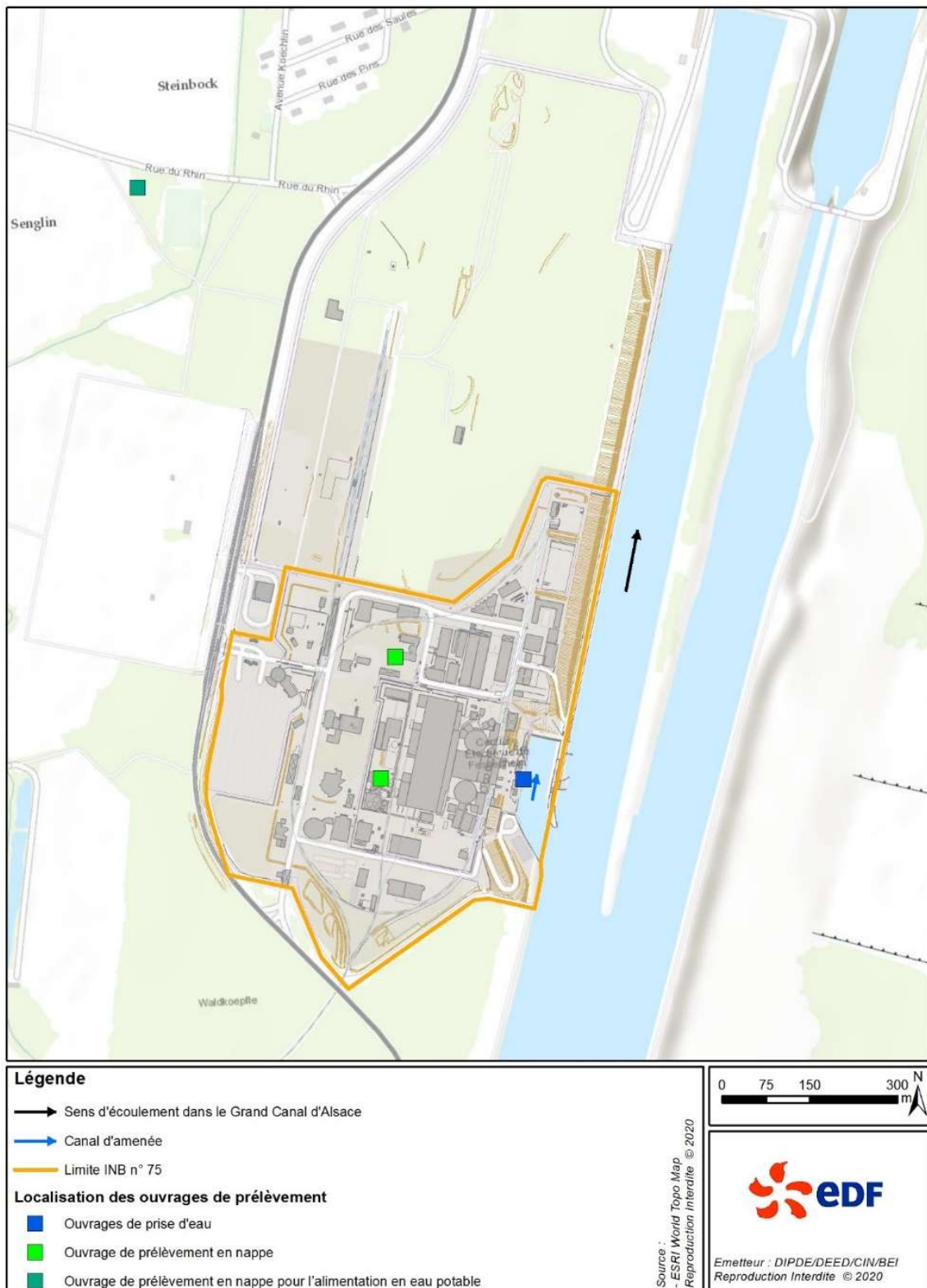
Figure 2.o Implantation des ouvrages de prélèvement d'eau
