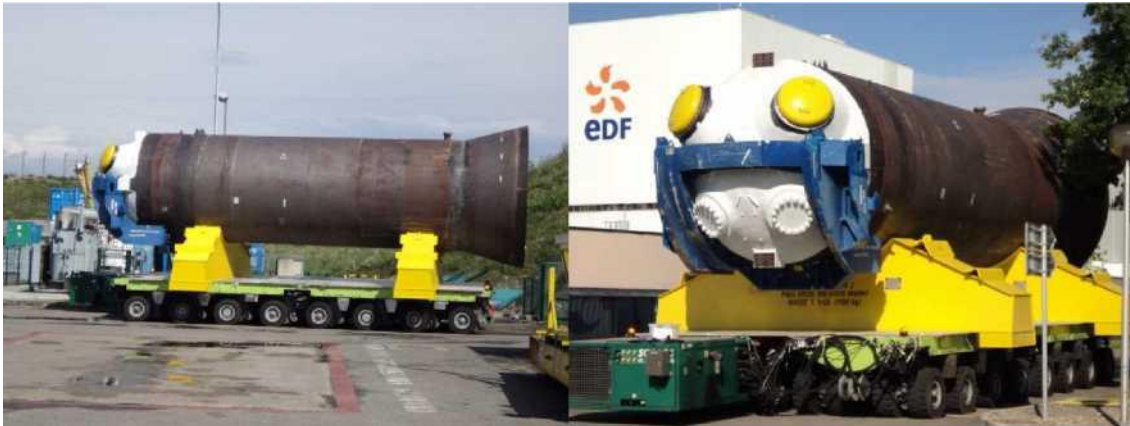
Abbildung 9.j Abbildung einer Zirkulation eines großen Bauteils – Ersatzbetrieb für Dampfgeneratoren – CNPE Fessenheim 2011
