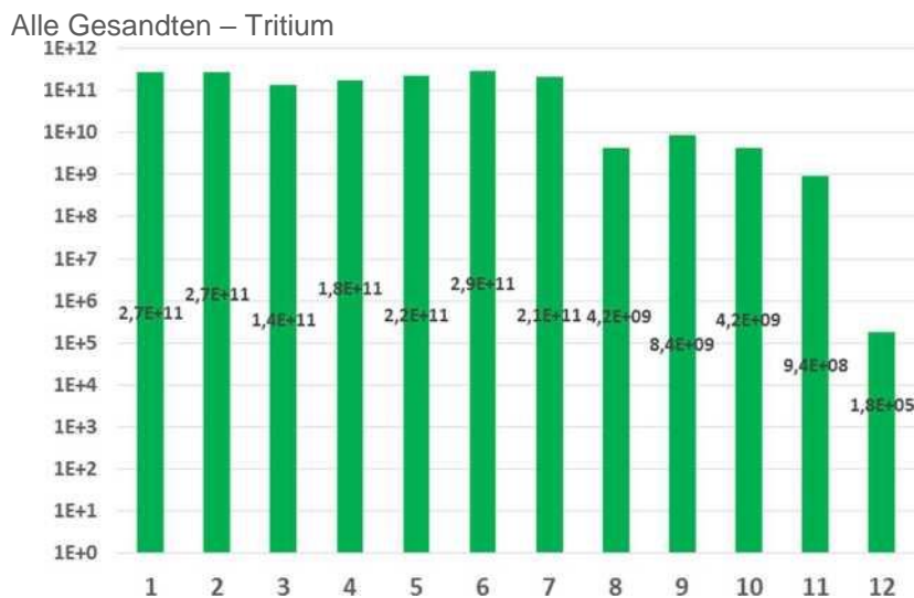
Abbildung k Geschätzte Tätigkeiten pro Jahr der radioaktiven Freisetzungen in die Luft durch Tritium
