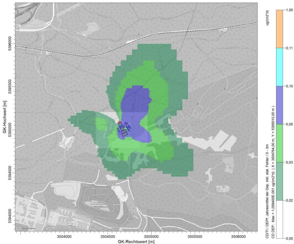
Abbildung 44. Immissions-Gesamtzusatzbelastung der Deposition von Cadmium Cd und Thallium Tl in  $\mu\text{g}/(\text{m}^2 \text{ d})$  durch die Emissionen des Hauptkamins. Kartengrundlage: OpenStreetMap.
