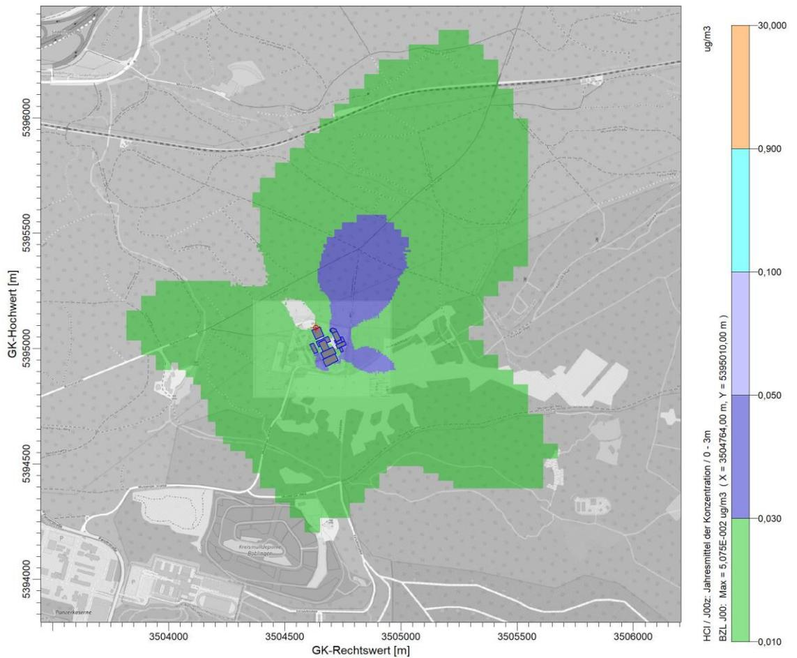
Abbildung 45. Immissions-Gesamtzusatzbelastung der Konzentration von Chlorwasserstoff HCl in  $\mu\text{g}/\text{m}^3$  durch die Emissionen des Hauptkamins. Kartengrundlage: OpenStreetMap.
