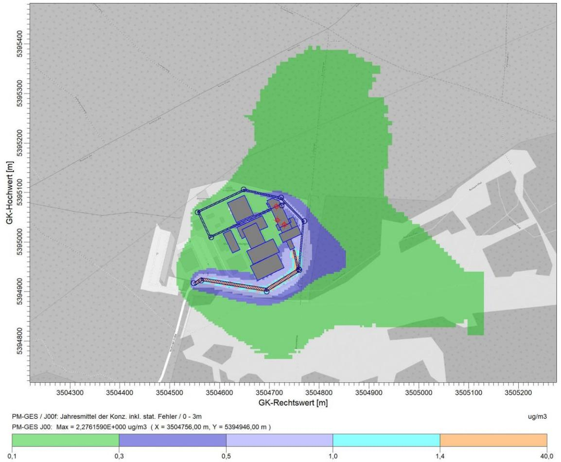
Abbildung 24. Immissions-Zusatzbelastung Partikel PM<sub>10</sub> in µg/m<sup>3</sup> durch den Fahrverkehr auf dem Betriebsgelände, die Siloaufsatzfilter und den Hauptkamin. Karte genordet. Hintergrundkarten: © OpenStreetMap [37] und [39].
