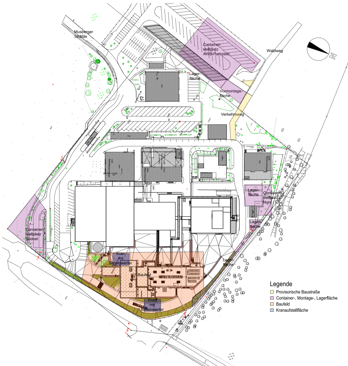
Abbildung 6: Baustelleneinrichtungsflächen inkl. Verkehrsanbindung
